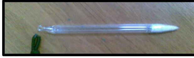
Şekil 6.3 Büyütülen kristalin tüp içerisindeki görüntüsü
