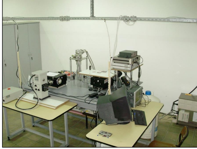
Şekil 6.8 Çalışmalarımızda kullandığımız optik spektrum ölçüm seti
