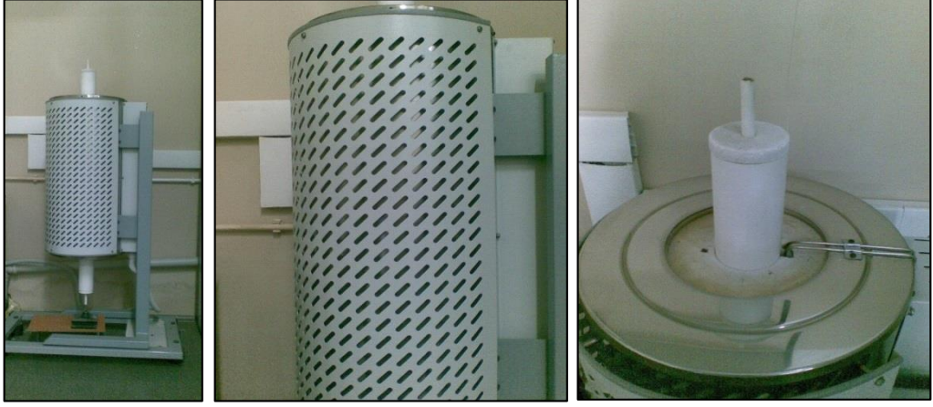
Şekil 6.1 Üç sıcaklık bölmeli kristal büyütme fırını
