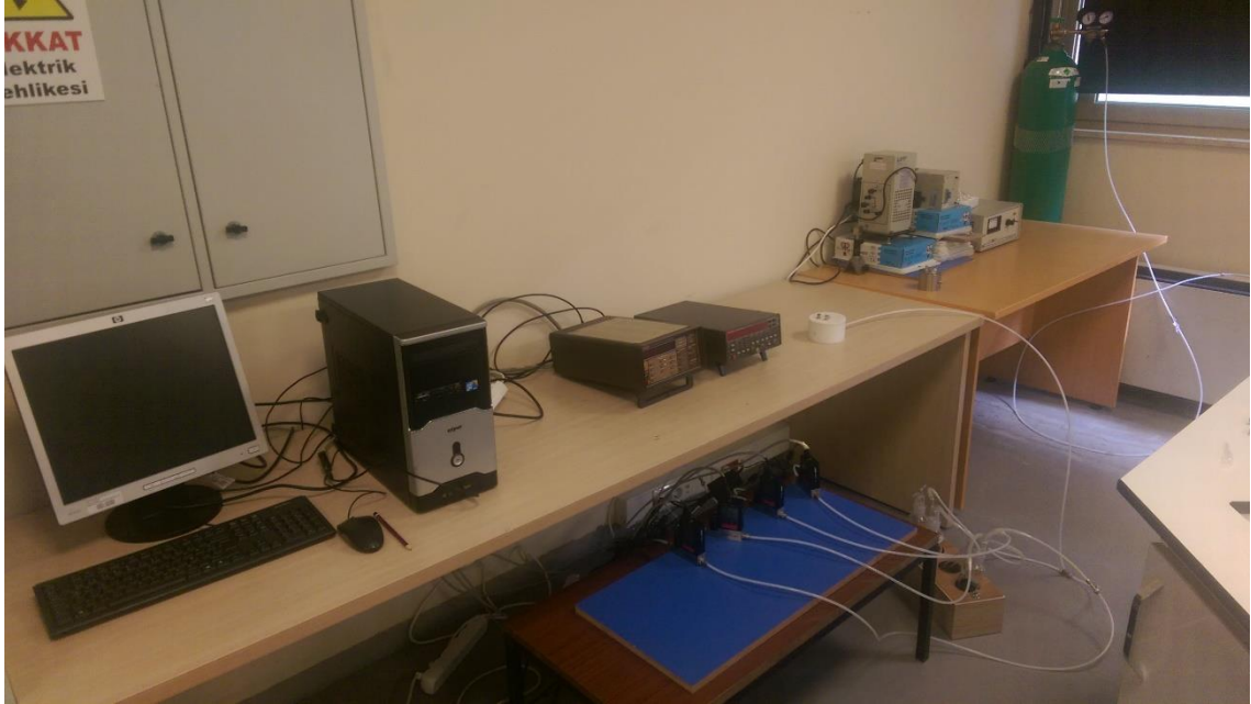
Kütle akış ölçerler Şekil 3. 6'da görüldüğü gibi gaz yıkama şişelerine bağlanmıştır. Kütle akış ölçerlerden gelen azot yardımı ile şişede bulunan uçucu organiklerin buharları süpürülmüştür. Azot, şişenin tepesinden sıvının içerisine doğru ilerleyen kanal yardımıyla ilerleyip şişenin yan kısımlarından yükselmektedir. Bu sırada şişe içindeki buharı dışarıya sürükleyip test odacığına götürmektedir.
