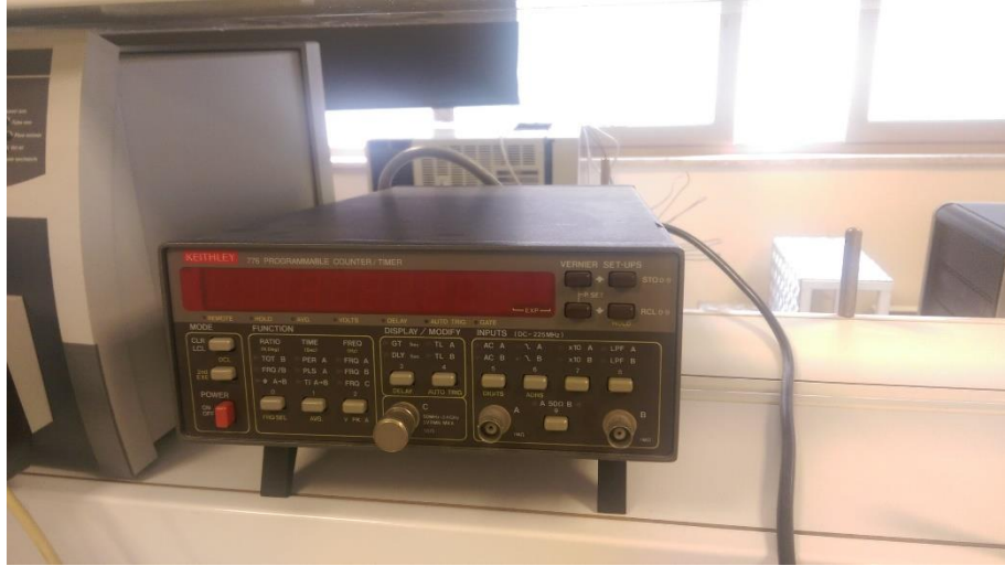
Şekil 3. 5 Rezonans frekansındaki değişimlerin ölçülmesinde kullanılan frekans metre
