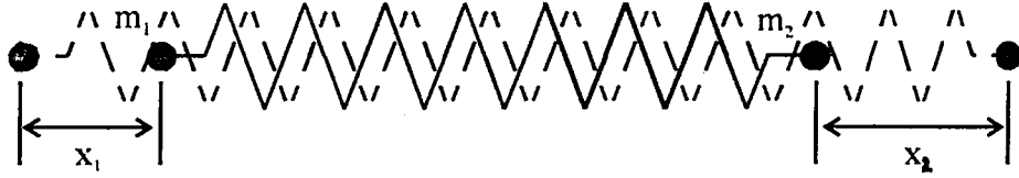
Şekil 3.1 İki atomlu bir molekülün titreşimleri için klasik model.
