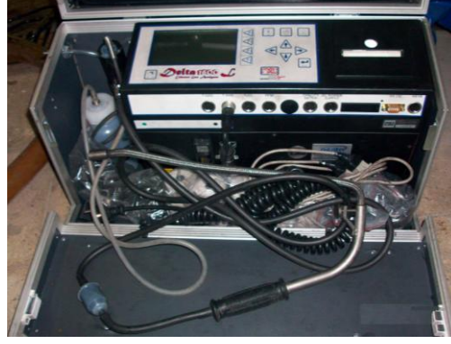
Şekil 4. 5 Emisyon ölçüm cihazı (MRU Delta 1600L)
