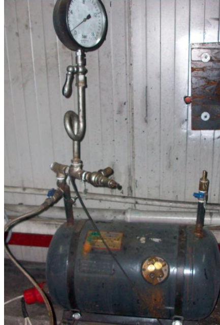
Şekil 4. 8 Buhar eldesi için kullanılan tüp
