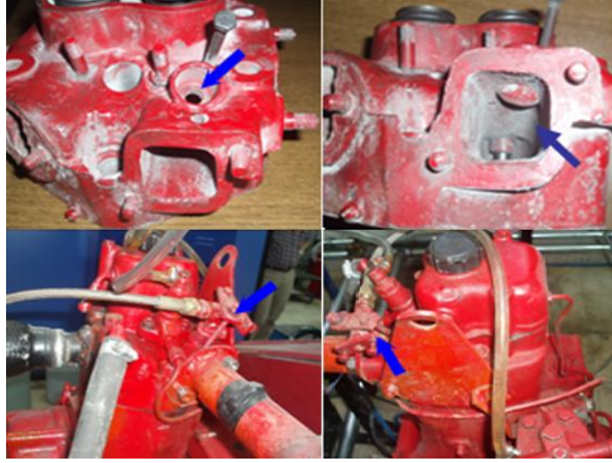
Şekil 4. 9 Silindir kapağına açılmış enjektör yuvası ve enjektör yuvasına takılmış buhar enjektörü [59]
