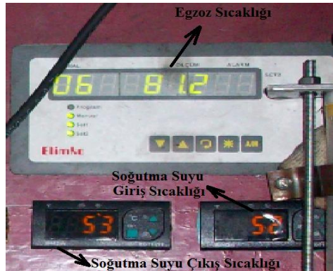
Şekil 4. 4 Sıcaklık ölçüm düzeni
