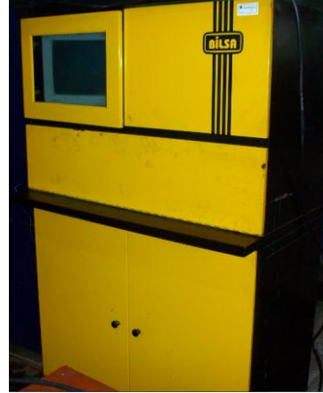
Şekil 4. 6 Emisyon ölçüm cihazı (Bilsa Mod 5200)
