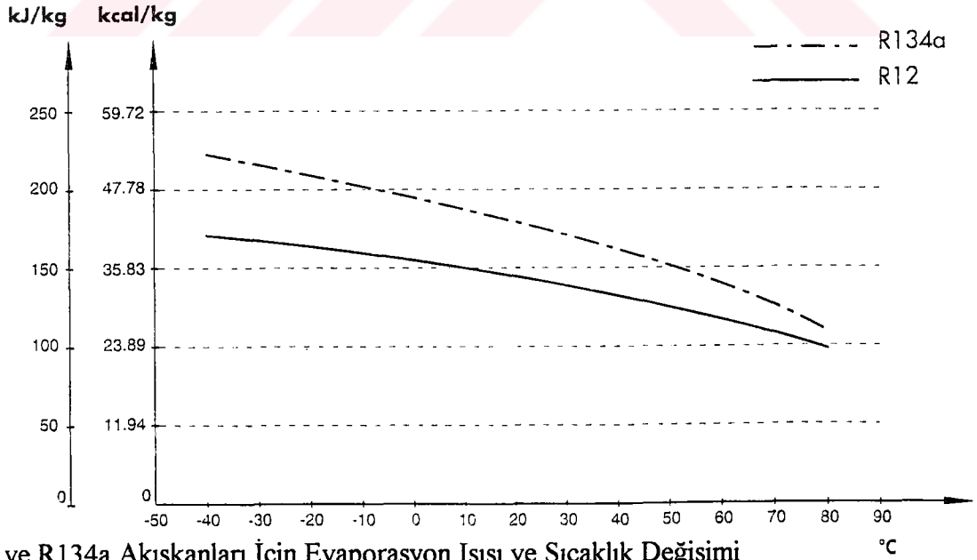
Şekil 4.4 R12 ve R134a Akışkanları İçin Evaporasyon Isısı ve Sıcaklık Değişimi
