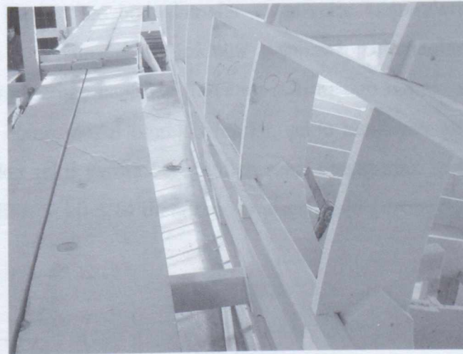
Şekil 8.12 Borda stringerlerinin dizayn postalarına montaj detayı
