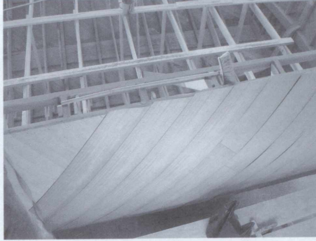
Şekil 8.4 Birbirine çarpraz çakılan gövde kaplamaları
