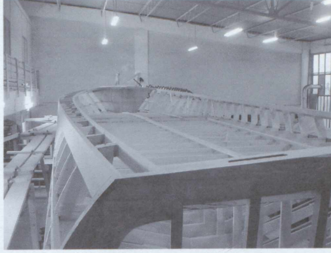
Şekil 8.10 Gövde sarma işleminden önce bütün elemanların montajı
