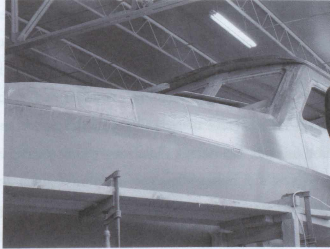
Şekil 8.29 Epoksi elyaf ve epoksi macun uygulanması
