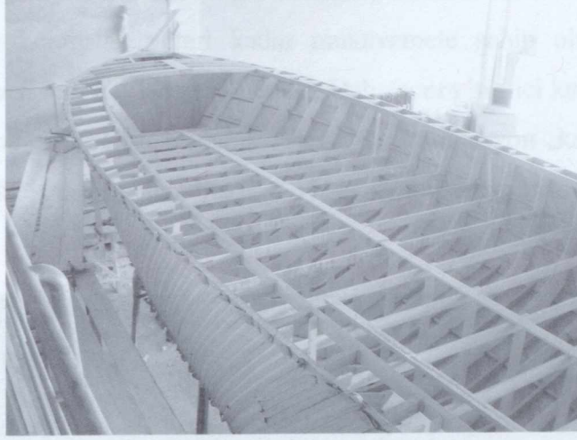
Şekil 8.15 Tekne gövdesinin oluşturulması ve gövde laminasyonu
