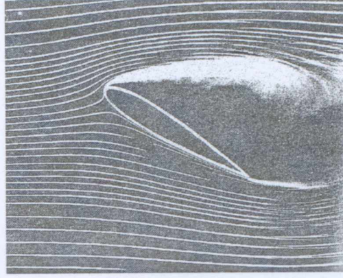
Şekil 3.22 Yüksek hücum açısında, dumanla akış görüntüleme: bir taşıyıcı üzerinde stol olmuş akış (White, 2004)
