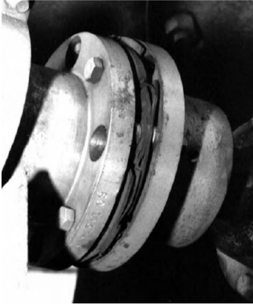
Şekil 3.2 Layn kaçıklığından kaynaklanan kaplin arızası.
