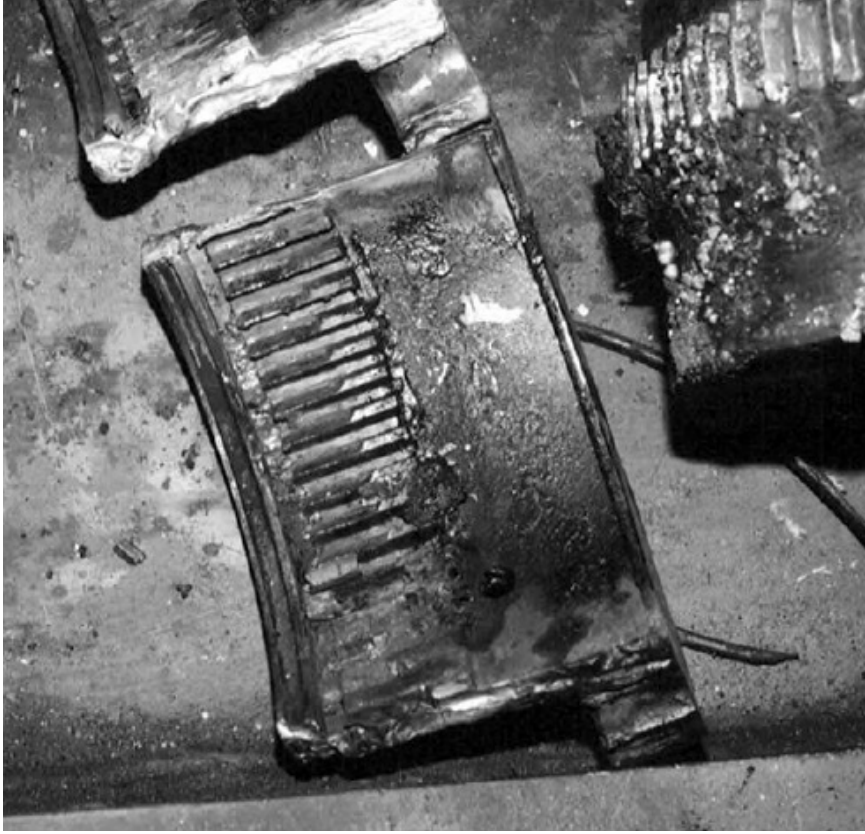
Şekil 3.8 Layn kaçıklığı nedeniyle kaplinde oluşmuş aşınma (Piotrowski, 2007).
