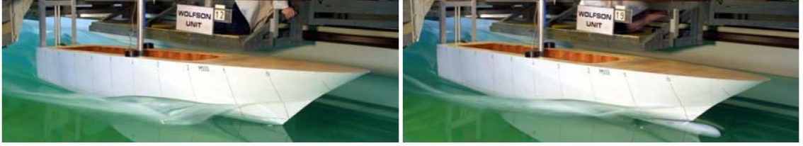
Şekil 2.2 Yumrubaşsız (solda) ve yumrubaşlı (sağda) bir motoryata ait model deneyi esnasında gözlemlenen dalga oluşumları, Fn = 0,55 (Oossanen vd. [7])
