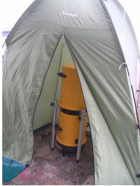
Şekil 5.4 A10 mutlak gravite ölçer ve kötü hava koşullarından kaçınma
