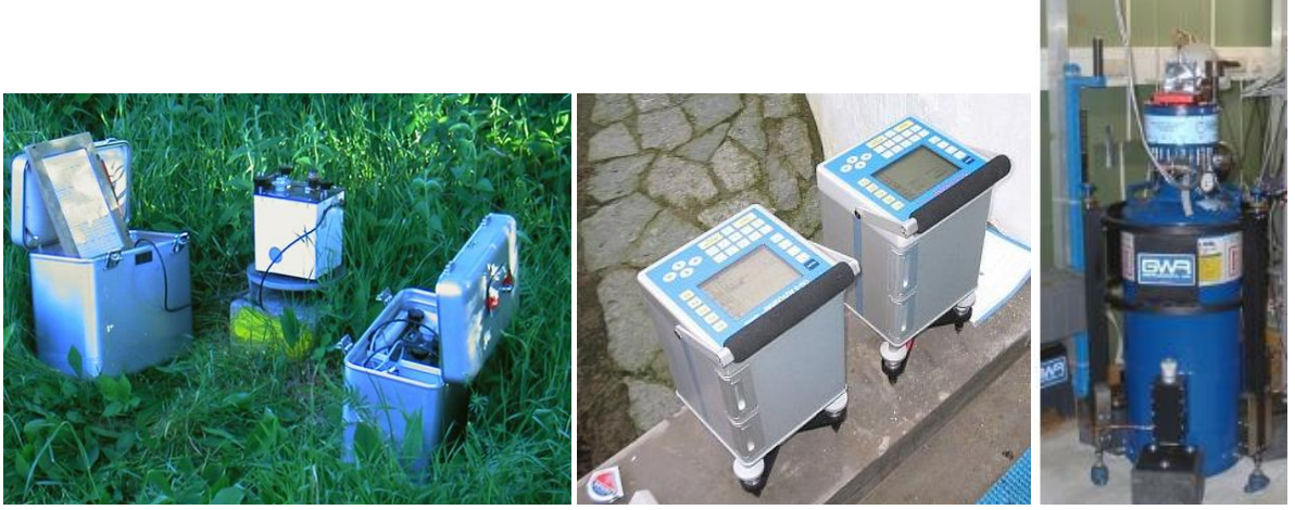
Şekil 3.3 LaCoste Romberg (solda), Scintrex CG-5 (ortada) ve GWR SG30 (süper iletken – sağda) marka bağıl gravite ölçerler
