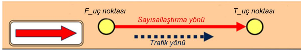
Şekil 4.3 Trafik yönünün sayısallaştırma yönüyle aynı olduğu durum
