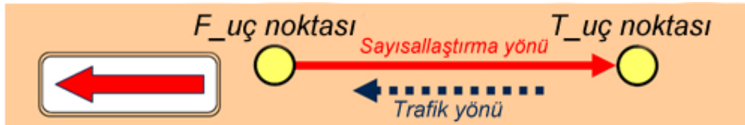
Şekil 4.3 Trafik yönünün sayısallaştırma yönüyle aynı olduğu durum
