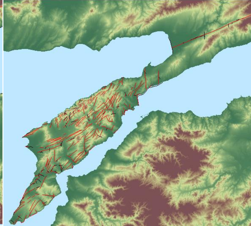
Şekil 4.32 Landsat 7. bantına (3x3) yüksek geçirgen filtre uygulandıktan sonra sonuç çizgisellikler
