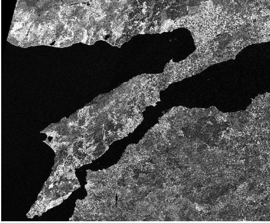
Şekil 3.19 Yüksek geçirgen filtre uygulanmış 7. bant görüntüsü
