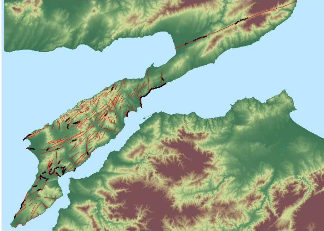
Şekil 4.33 Landsat 7. bantına (3x3) yüksek geçirgen filtre uygulandıktan sonra elenen çizgisellikler
