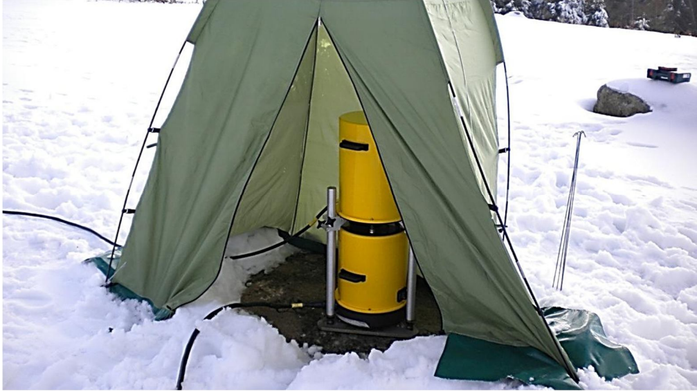
Şekil 7. 7 KIRT noktasında mutlak gravite ölçümü
