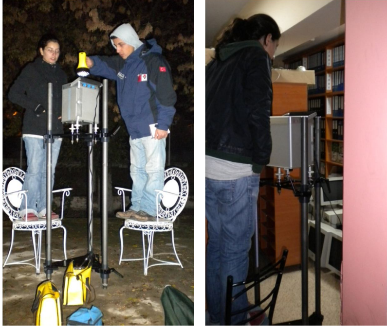
Şekil 7. 13 BTLT (solda) ve HAYT (sağda) düşey gradyent ölçümü
