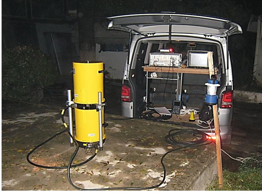
Şekil 7. 6 BTLT noktasında mutlak gravite ölçümü
