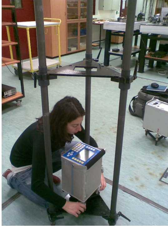
Şekil 7. 14 UME laboratuvarında düşey gradyent ölçümü
