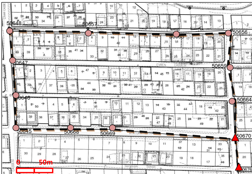
Şekil 6. 37 Kapalı poligon güzergahının (Güzergah II) sayısal harita üzerinde gösterimi
