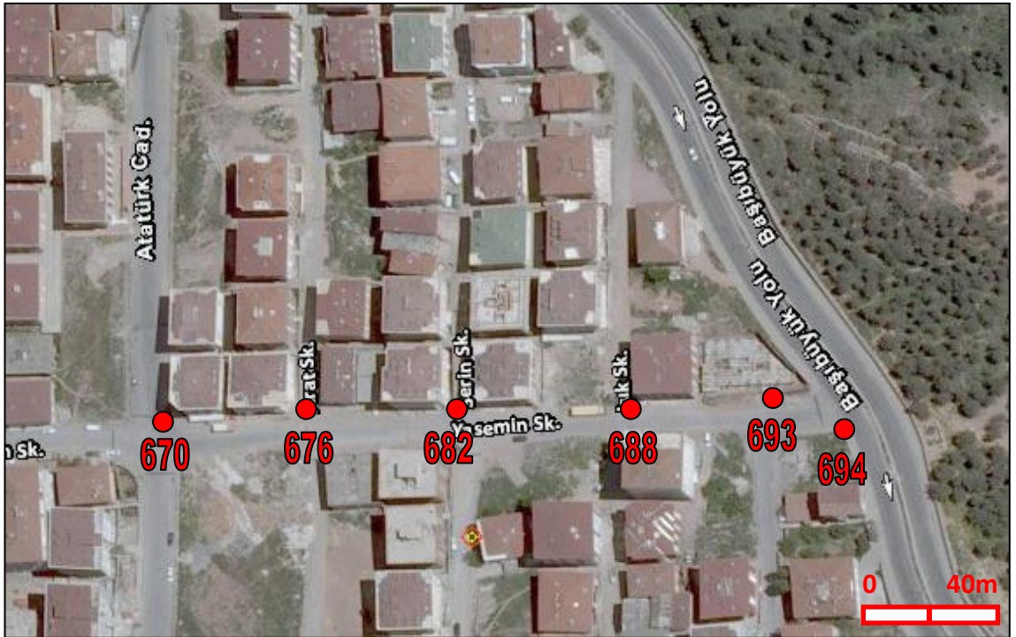
Şekil 6. 12 Statik ölçüm yapılan 670, 676, 682, 688, 693 ve 694 numaralı kadastral noktaların uydu fotoğrafı üzerinde gösterimi
