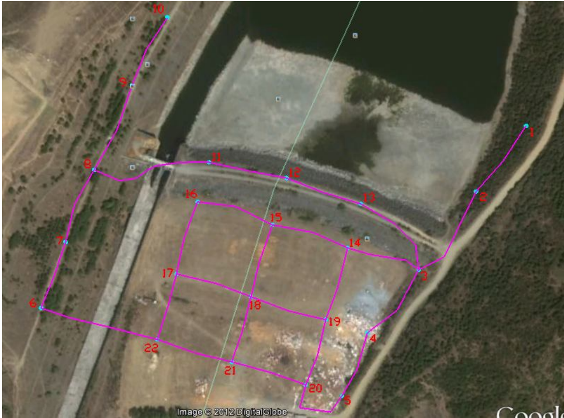
Şekil 6. 3 Alibey Barajı Nivelman Ağı Üstten Görünüm
