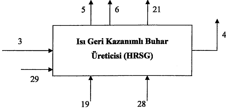
Şekil 5.5 Isı geri kazanımlı buhar üreticisi (HRSG) akım şeması
