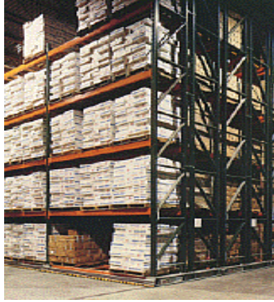
Şekil 4.15 Hareketli raf sistemleri (Salcan, 2007a).
