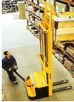
Şekil 4.33 Elektrikli istif makinesi (Salcan, 2007a).
