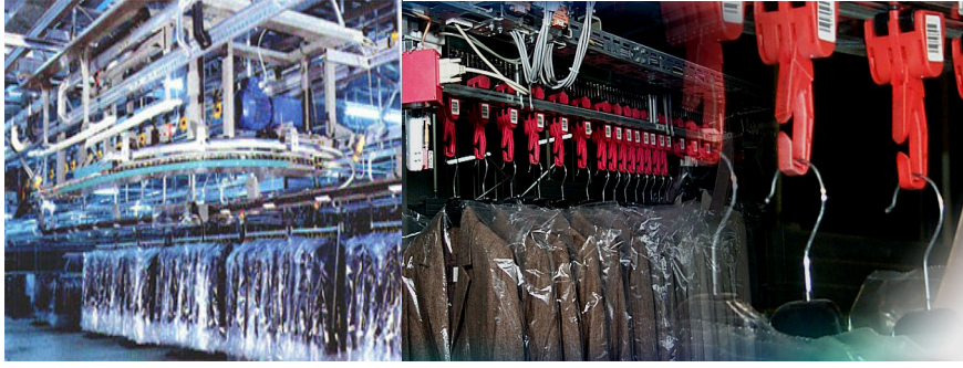
Şekil 4.20 Askılı konveyör depolama sistemleri (Salcan, 2007a).
