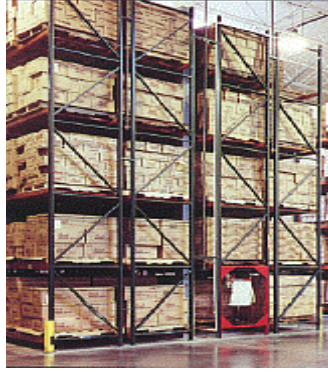
Şekil 4.10 İkili derinlikte raf sistemi (Salcan, 2007a).
