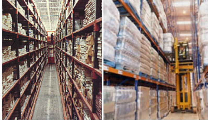
Şekil 4.19 Dar koridorlu depolama sistemleri (Salcan, 2007a).
