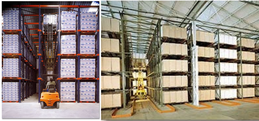
Şekil 4.12 İçine girilebilir raf sistemleri
