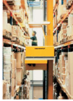
Şekil 4.31 Dar koridor istif makineleri (Salcan, 2007a).
