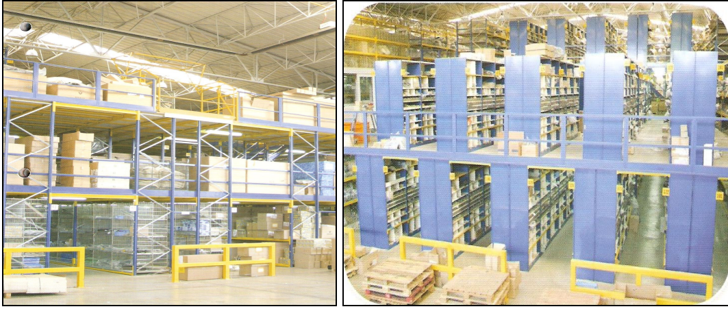
Şekil 4.22 Mezanin tip raf sistemleri (Salcan, 2007a).
