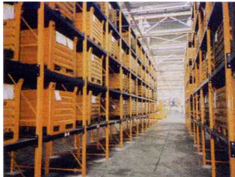
Şekil 4.11 Tek paletli raf sistemleri
