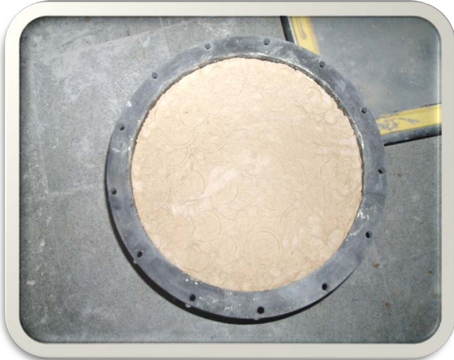
Şekil A. 4 Reaktörlere taban örtü malzemelerinin yerleştirilmesi
