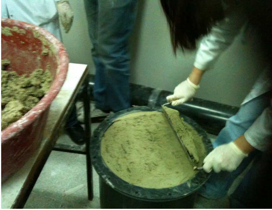
Şekil A. 4 Reaktörlere taban örtü malzemelerinin yerleştirilmesi
