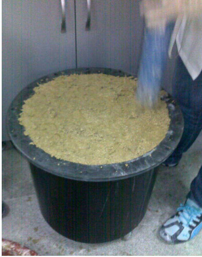
Şekil 4. 2 Reaktörlerin zemin tabakalarının doldurulması
