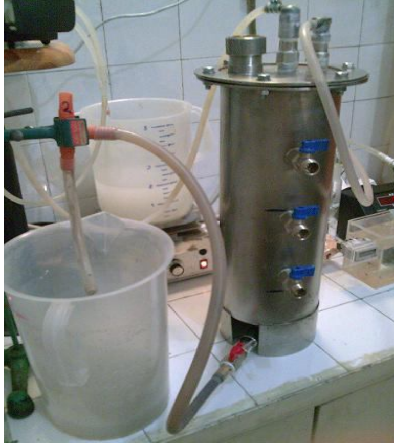
Şekil 5.2 Krom çelikten yapılmış anaerobik reaktör
