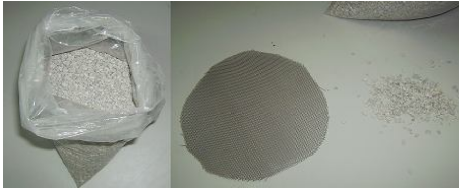
Şekil 4.1 Reaktörün tabanında kullanılan çakıl ve telin görüntüsü
