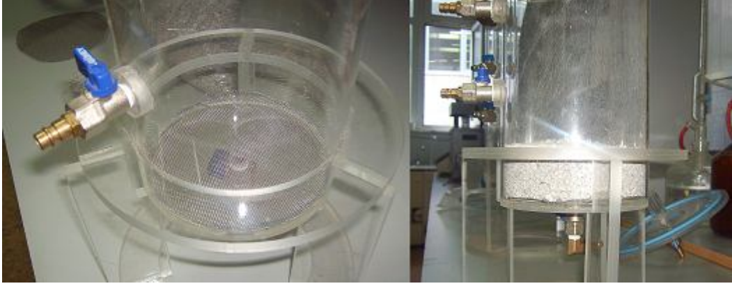
Şekil 4.2 Reaktörün tabanına yerleştirilen telin ve çakılın görüntüsü
