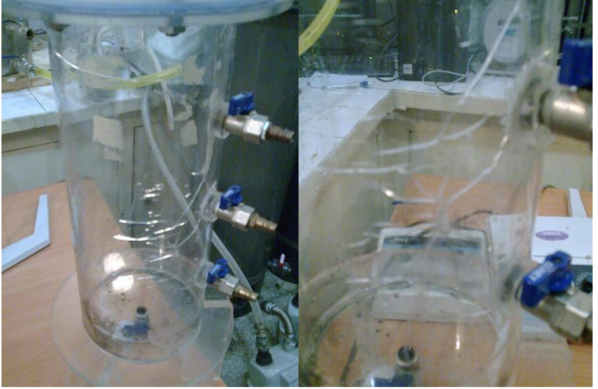
Şekil 5.1 Pleksiglas malzemedan yapılmış anaerobik reaktörde meydana gelen çatlaklıklar
