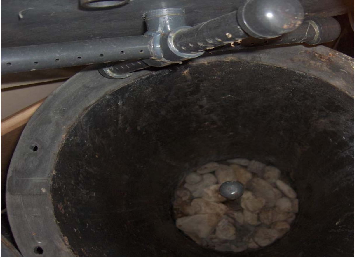
Şekil 5.5 Sızıntı suyu geri devir borusunun (T borusu) ve reaktörün iç kısmının görünüşü
