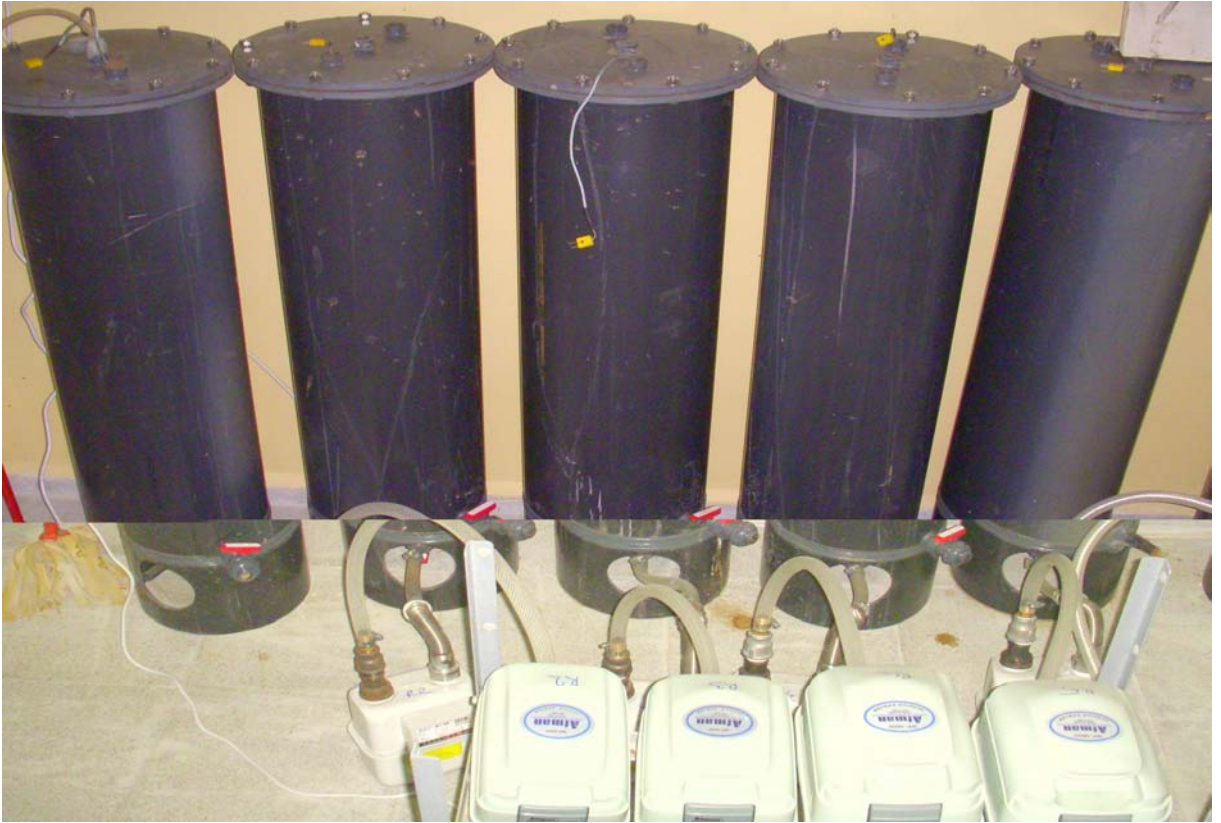
Şekil 5.3 Anaerobik ve aerobik reaktörlerin işletme aşamasına ait görüntü
