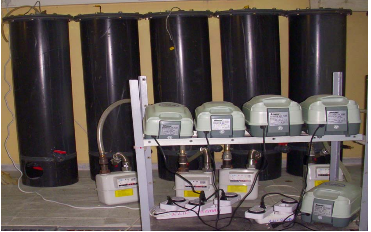
Şekil 5.2 Anaerobik ve aerobik reaktörlerin genel görüntüsü
