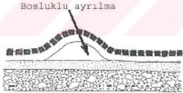
Fig. 4.1 Dikey ve yatay baskılar sonucunda mozaik tabanda meydana gelen çeşitli deformasyonlar ve harç katmanlarının ayrılması.
