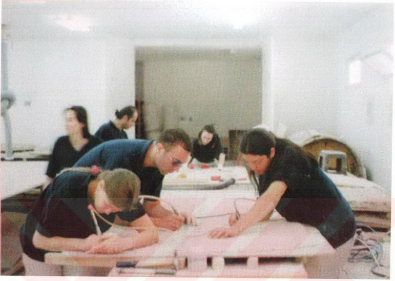
Fig. 5.36 Parçalı yöntemle kaldırılan mozaik panellerine hassas pinomatik aletlerle yapılan arka temizliği. Zeugma mozaiklerinin restorasyonu, CCA restorasyon atölyesi, Gaziantep Müzesi.
