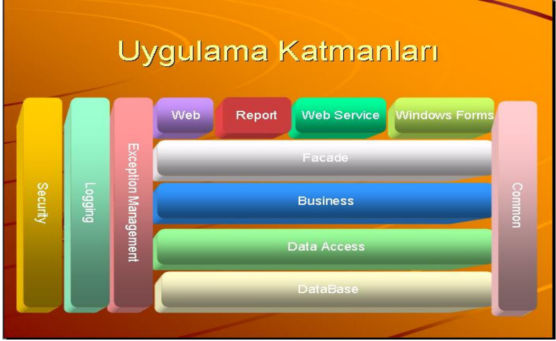
Şekil 3.2 HYS uygulamasında kullanılan çok katmanlı framework yapısı
