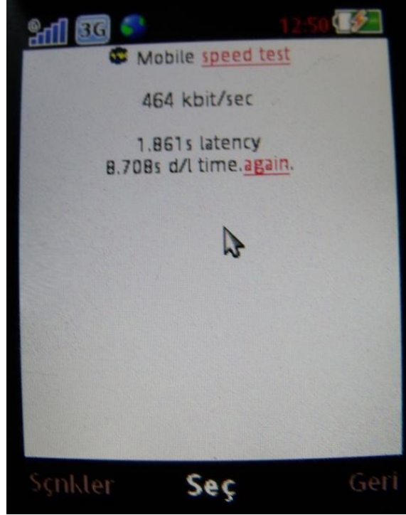
Şekil 7.2 A operatörü için kullanıcı ekipmanı üzerinden bant genişliği ve gecikme ölçümü
