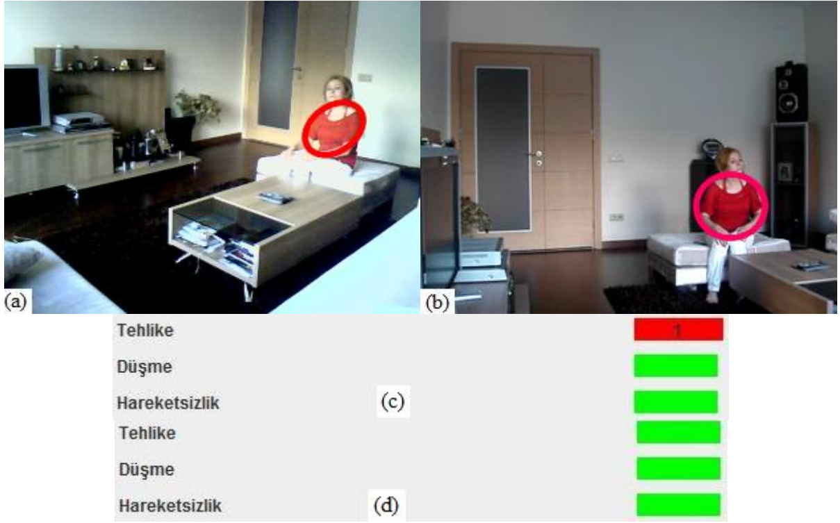
Şekil 4.24 Çoklu kamera sistemi ile birinci tehlikeli bölgenin tespit edilmesi
