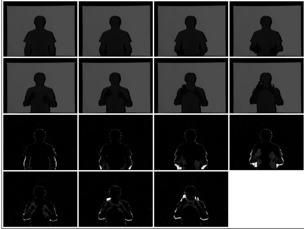
Şekil 4. 3 Tid’de “günaydın” kelimesinin bir işaretçi tarafından uygulanaşına ait seçilmiş derinlik haritası ardışıl çerçevesleri ve bu çerçeveslere ait fark imgeleri
