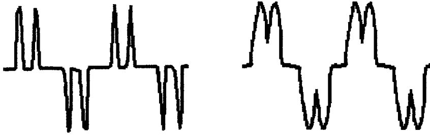
Şekil 5.1 6-Darbeli doğrultucunun, filtresiz ve %3 hat reaktörlü giriş akım dalga şekli.
