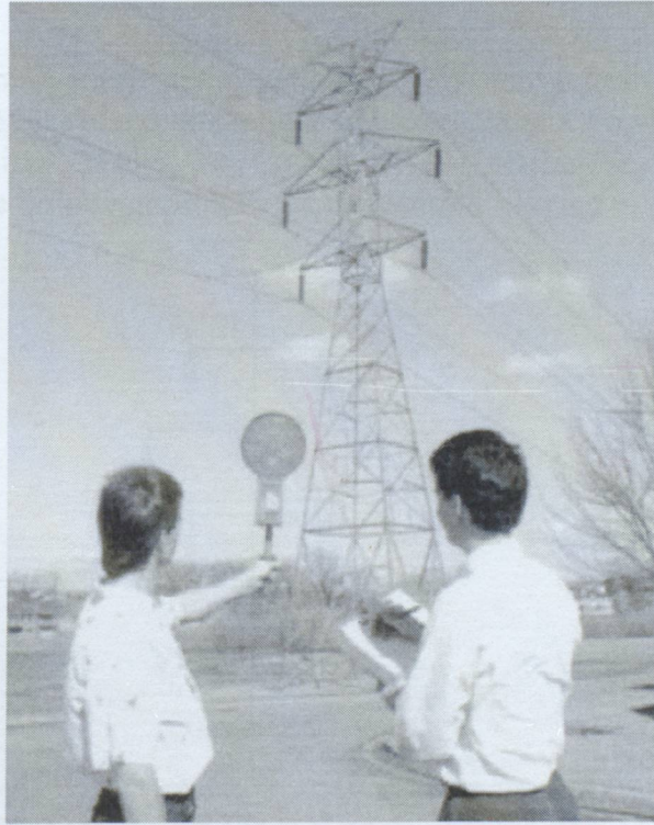
Şekil 6.2 Enerji iletim hattında alan ölçümü
