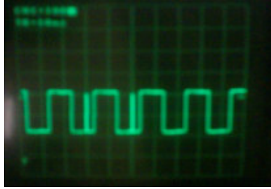
Şekil 4.12 Kare dalga PWM yönteminde motora uygulanan Faz-Nötr gerilimi.
