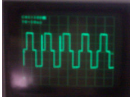
Şekil 4.11 Kare dalga PWM yönteminde motora uygulanan Faz-Faz gerilimi.
