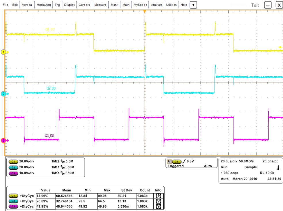
Şekil 4.19 iDSBB düşürücü çalışma için “drain-source” işaretleri
