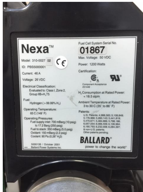
Şekil 4.10 Nexa™ PEM Tipi yakıt pili etiket değerleri
