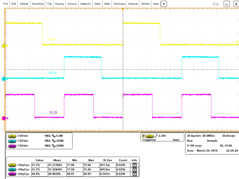
Şekil 4.18 iDSBB düşürücü çalışma için “gate – source” işaretleri
