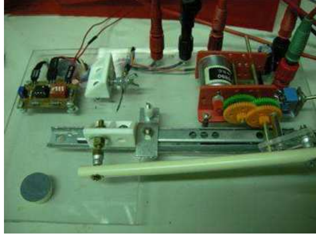
Şekil 3.6 Membranın algılama yeteneğini test etmek için kurulan düzenek (Fortuna vd., 2009b)
