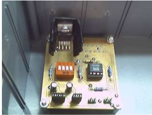
Şekil 4.3 Koşullandırma devresinin (conditioning circuit) prototipi (Fortuna vd., 2009b)
