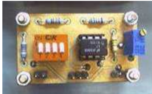
Şekil 3.5 Kısa devre akımını ölçmek için kullanılan devrenin kartı (Fortuna vd., 2009b)
