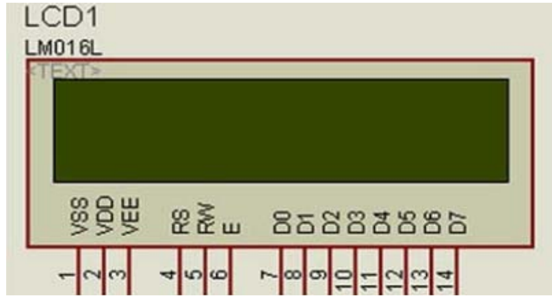
Şekil 4.2 HD44780 sürücülü LCD’nin bacak bağlantıları
