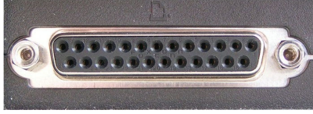
Şekil 2.5 DB25 paralel port konnektörü
