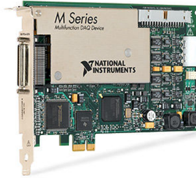
Şekil 2.80 PCIe yolu kullanan giriş-çıkış birimi örneği - PCIe-6251 (www.ni.com)
