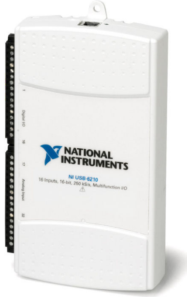
Şekil 2.86 USB kullanan giriş-çıkış birimi örneği - USB-6210 ( http://www.ni.com )
