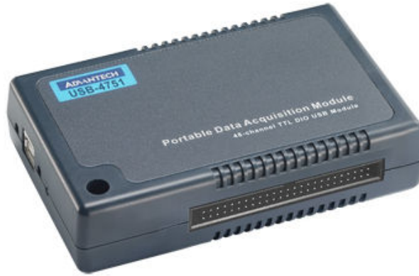
Şekil 2.83 USB'li giriş-çıkış birimi örneği – Advantech USB-4751 ( http://www.advantech.com )
