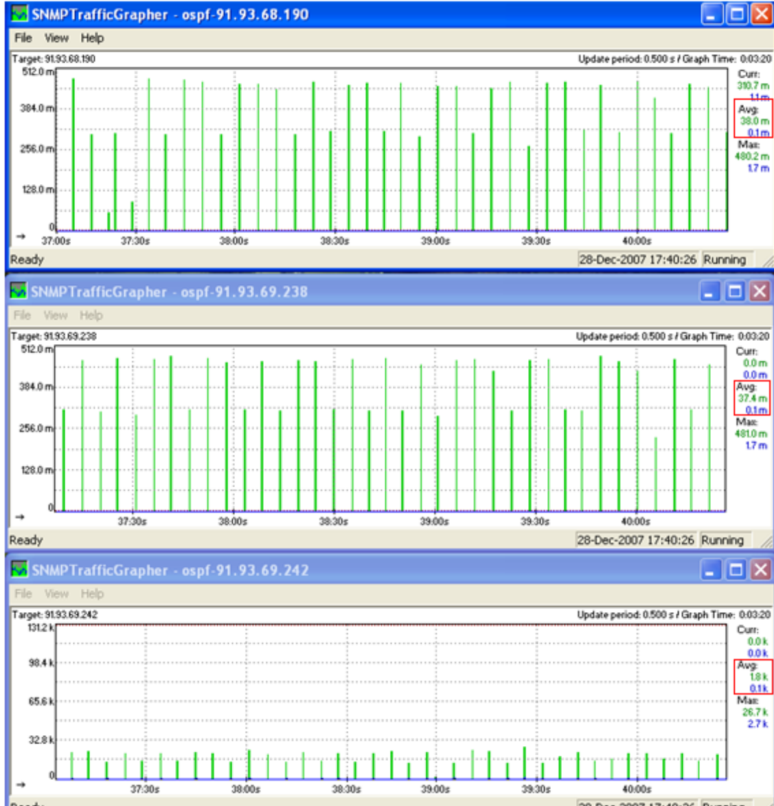
Şekil 5.3 - OSPF üzerinden akan trafiğin gözlemlenmesi
