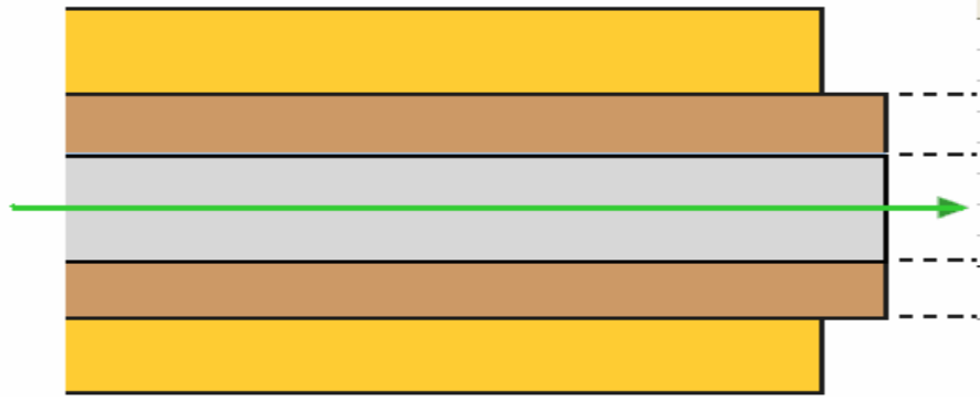
Şekil 2.9 Basamak indisli tek modlu optik fiber
