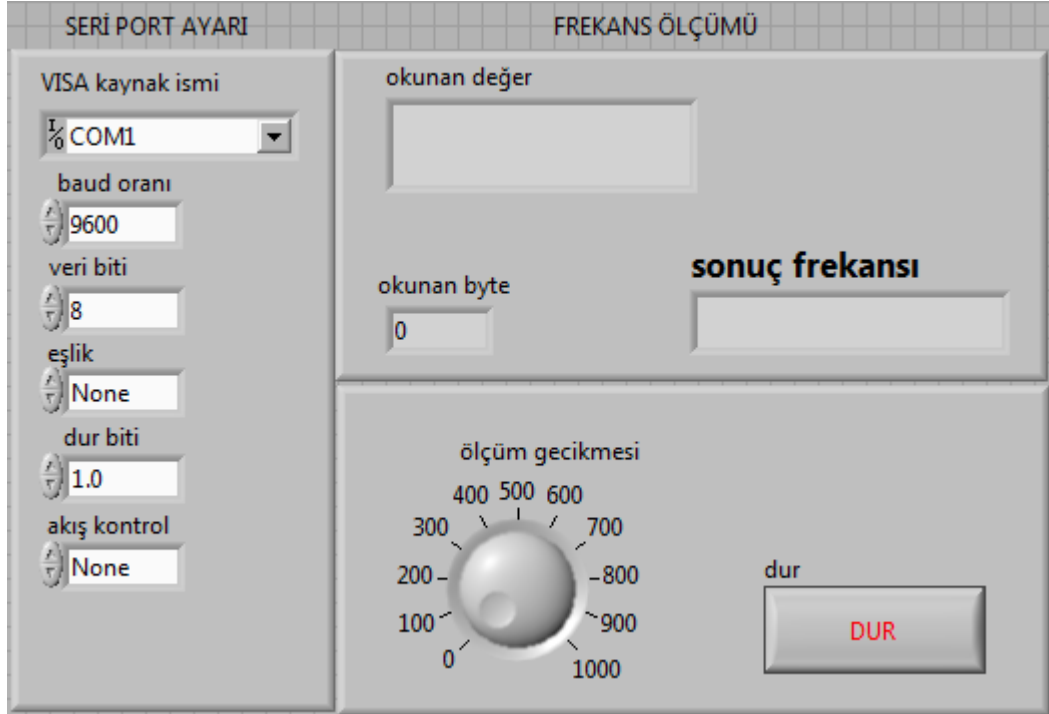
Şekil 6.4 Endüstriyel otomatik frekansmetre sisteminin LabVIEW ön panel görünümü
