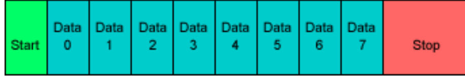
Şekil 4.2 UART haberleşme yapısı
