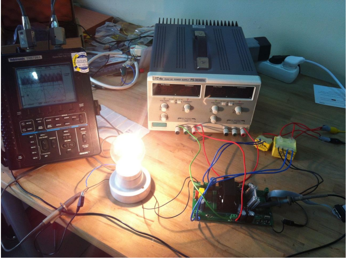
Şekil 4.11 İnverterin laboratuvar ortamında incelenmesi
