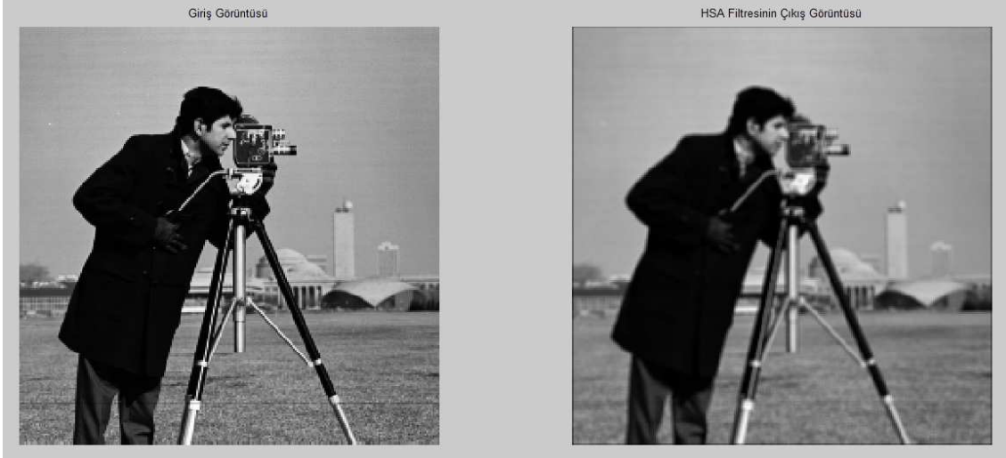
Şekil 2.14 HSA ile alçak geçiren filtreleme uygulaması
