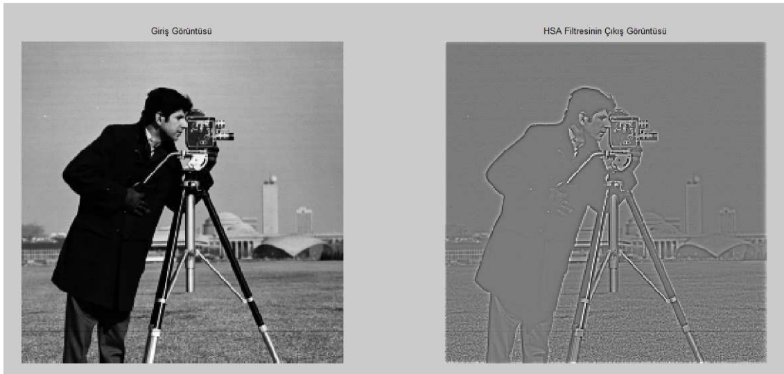
Şekil 2.13 HSA ile kenar belirleme uygulaması
