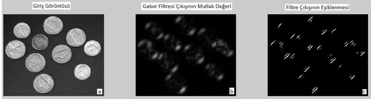
Şekil 2.20 Giriş görüntüsünden 135^\circ açısında yönelmiş bileşenlerin çıkartılması (\omega_x = \pi/4, \omega_y = \pi/4)
