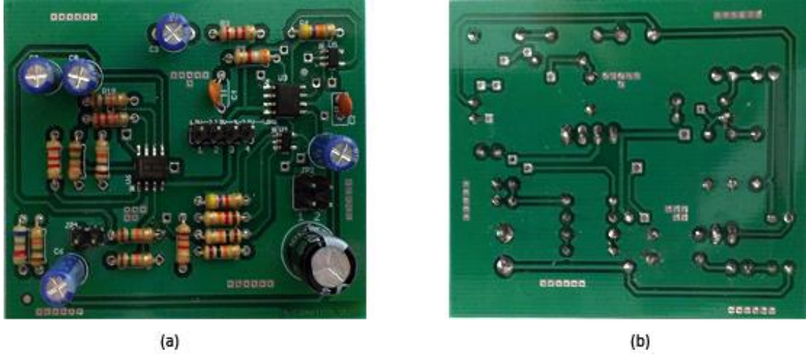
Şekil 3.18 (a) Elektronik stetoskop analog sinyal işleme birimi PCB ön yüzeyi (b) analog sinyal işleme birimi PCB arka yüzeyi
