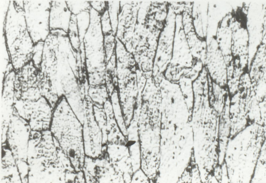
Sekil 50. 5 no'lu numune, %51 deformasyon, 600 C'de 1 saat tavlama
