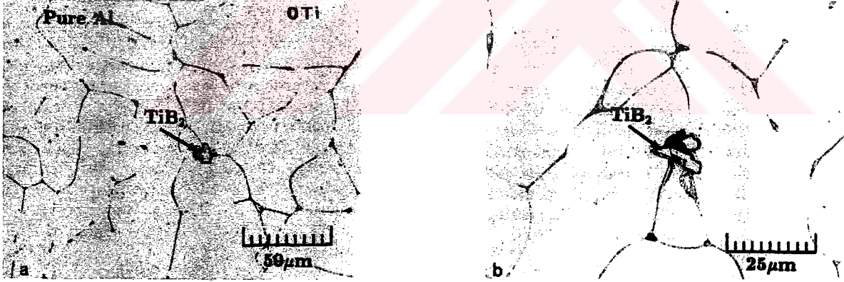
Şekil 2.2 Ti alaşımı içermeyen sıvı metalde TiB_2 a) tek parça b) parçacık kümesi (Mohanty, 1995)
