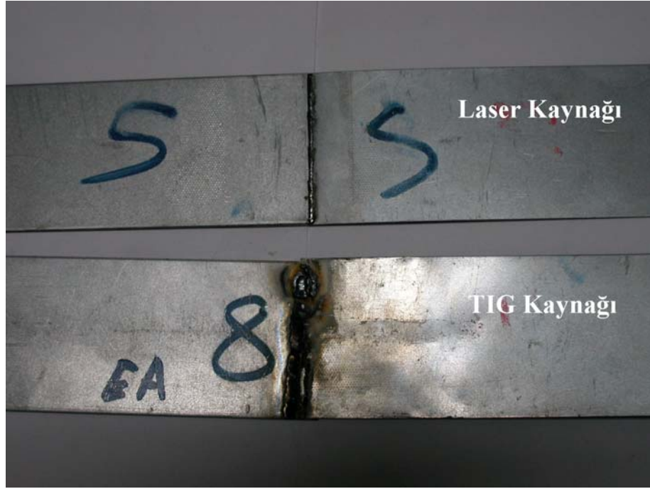
Şekil 7.7 Yük taşıyıcı kiriş ile taban panel malzemesinin TIG kaynağı ve Laser kaynağı gerçek görüntüsü.
