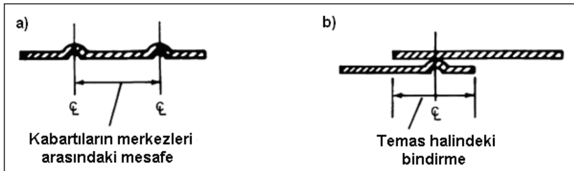
Şekil 6.2 a) kabartıların merkezleri arasındaki mesafe, b) üst üste bindirme teması (Metals Handbook V06, 1993)
