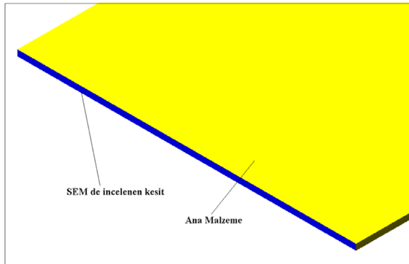
Şekil 7.14 Makasla kesilen sacın incelenen kısmı lacivertle gösterilmiştir.
