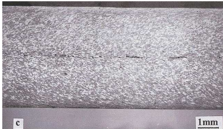
Şekil 4.8 8011 dökme rulonun hadde yönüne paralel kesiti. Döküm kalınlığı 5 mm, döküm hızı 1,5 m/ dakika (Ertan vd., 2000).
