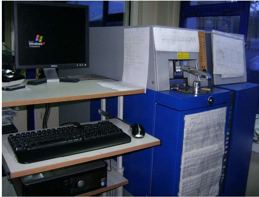
Şekil Ek 7.2 Malzemelerin kimyasal bileşimlerinin ölçüldüğü SpektroLab marka optik emisyon spektrometresi.
