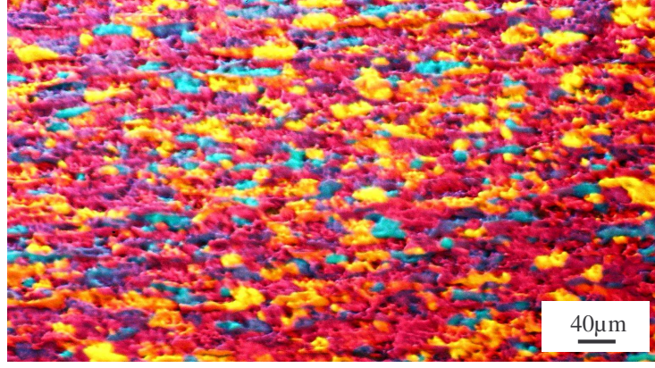
Şekil Ek 1.21 1. prosese ait 1mm kalınlığındaki tavlı malzemenin döküm yönüne paralel kesit kenar bölgesi
