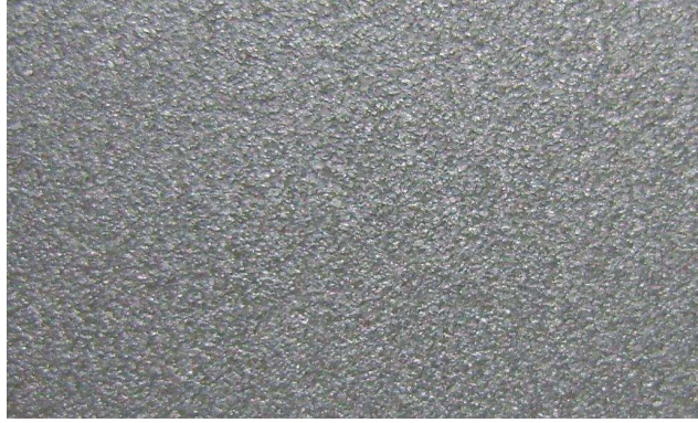
Şekil Ek 6.5 5,50mm kalınlığında 450°C sıcaklıkta homojenleştirme tavlı sonrası yüzey tane görüntüsü
