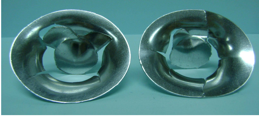
Şekil 7.14 1. prosese ait sert haldeki (tavsız) malzemenin derin çekme görüntüsü
