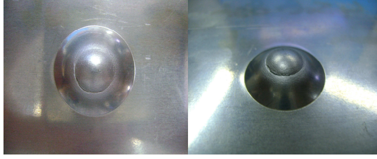
Şekil 7.13 5. prosese ait yeniden kristalleşme tavı görmüş malzemenin erichsen testi sonrası görüntüsü
