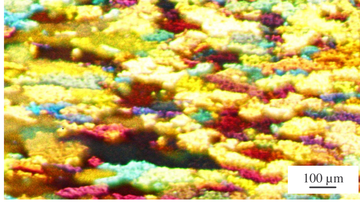
Şekil Ek 1.18 5,50mm kalınlıkta 450°C sıcaklıkta homojenleştirme tavlı sonrası döküm yönüne paralel kesit kenar bölgesi
