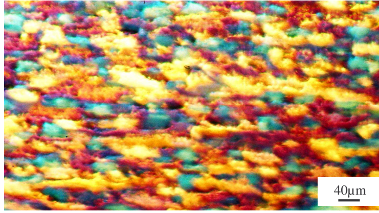
Şekil Ek 1.28 3. prosese ait 1mm kalınlığındaki tavlı malzemenin döküm yönüne paralel kesit kenar bölgesi
