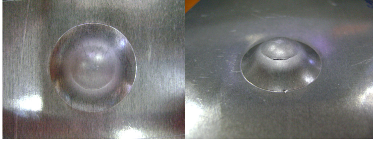
Şekil Ek 3.4 4. prosese ait yeniden kristalleşme tavı görmüş malzemenin erichsen testi sonrası görüntüsü
