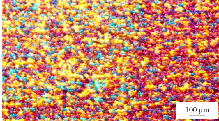
Şekil Ek 1.32 4. prosese ait 1mm kalınlığındaki tavlı malzemenin döküm yönüne paralel kesit merkez bölgesi
