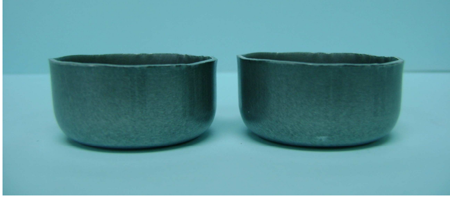
Şekil 7.14 1. prosese ait sert haldeki (tavsız) malzemenin derin çekme görüntüsü
