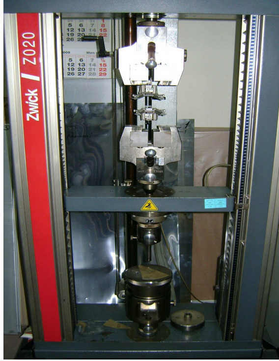
Şekil Ek 7.1 Malzemelerin çekme ve eriksen testlerinin yapıldığı Zwick Z20 marka test cihazı.
