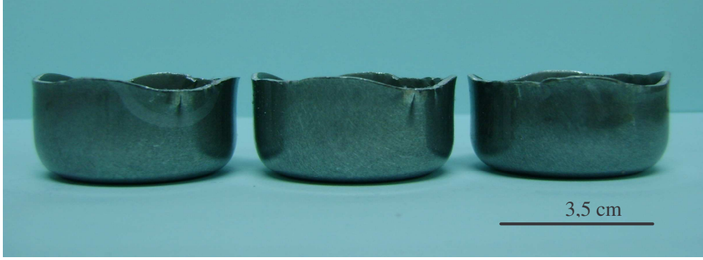
Şekil Ek 4.9 4. prosese ait sert haldeki (tavsız) malzemenin derin çekme görüntüsü
