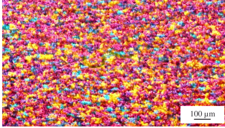
Şekil Ek 1.22 1. prosese ait 1mm kalınlığındaki tavlı malzemenin döküm yönüne paralel kesit görüntüsü
