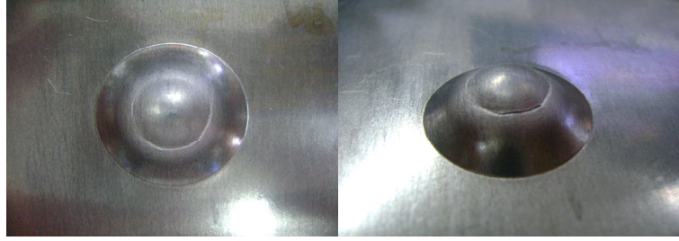
Şekil Ek 3.2 2. prosese ait yeniden kristalleşme tavlı görmüş malzemenin erichsen testi sonrası görüntüsü
