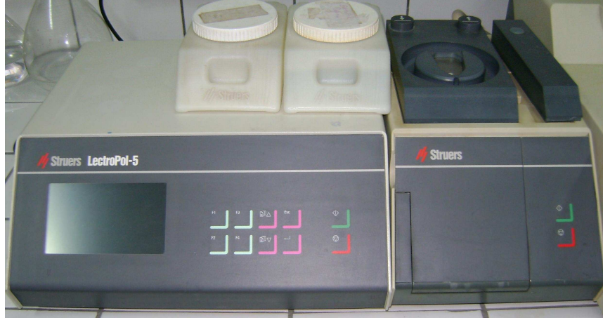
Şekil Ek 7.3 Makro ve mikro yapı numunelerinin elektrolitik dağlama işlemlerinin yapıldığı Struers LectorPol-5 marka elektro parlatma cihazı.
