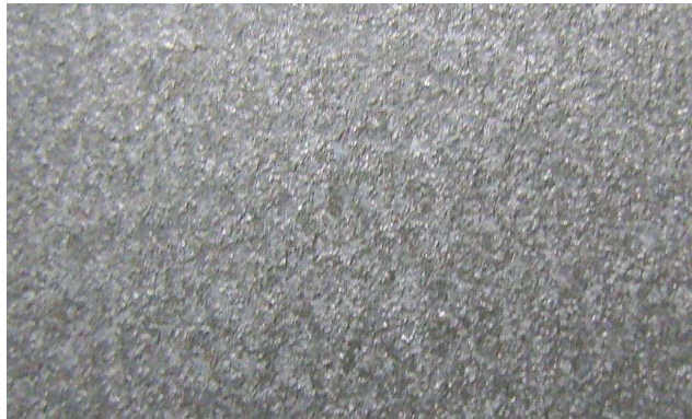
Şekil Ek 6.3 Döküm kalınlığında 450°C sıcaklıkta homojenleştirme tavı sonrası yüzey tane görüntüsü
