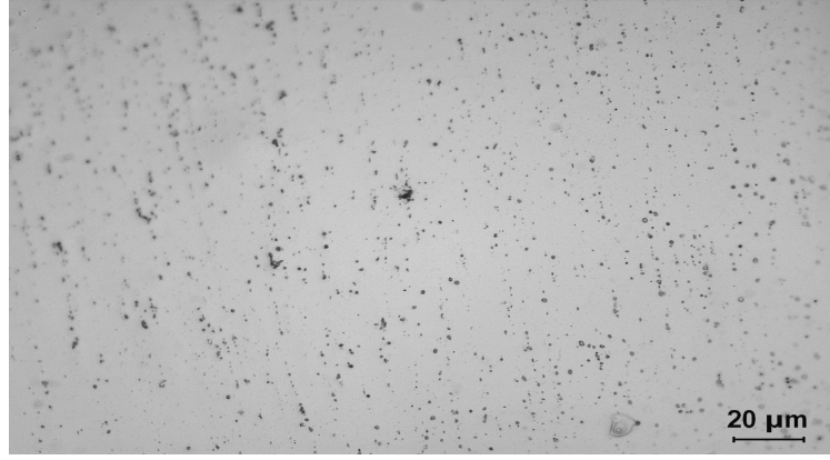
Şekil Ek 2.35 5. prosese ait 1mm kalınlığındaki tavlı malzemenin döküm yönüne paralel kesit kenar bölgesi
