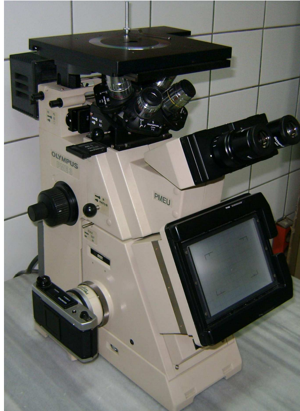
Şekil Ek 7.6 Makro yapı incelemelerinin yapıldığı Olympus PME3 marka optik ışık mikroskobu.
