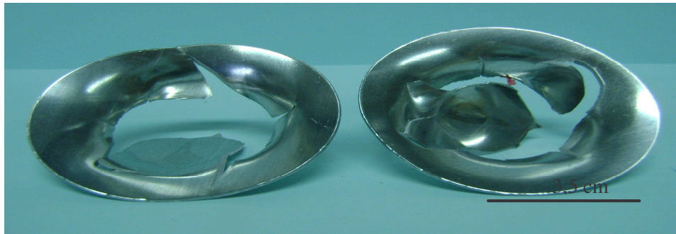
Şekil Ek 4.8 3. prosese ait sert haldeki (tavsız) malzemenin derin çekme görüntüsü
