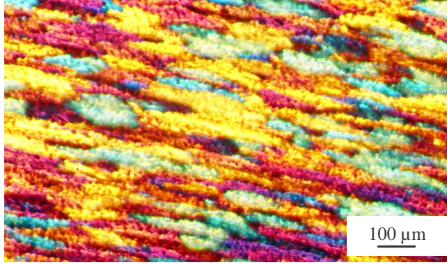
Şekil Ek 1.4 Döküm kalınlığında tavsız halde döküm yönüne paralel kesit kenar bölgesi
