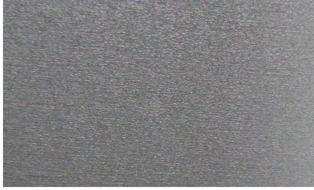
Şekil Ek 6.1 Döküm kalınlığında tavsız halde yüzey tane görüntüsü
