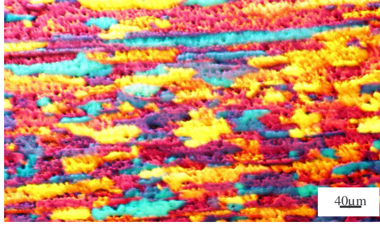
Şekil Ek 1.36 5. prosese ait 1mm kalınlığındaki tavlı malzemenin döküm yönüne paralel kesit kenar bölgesi
