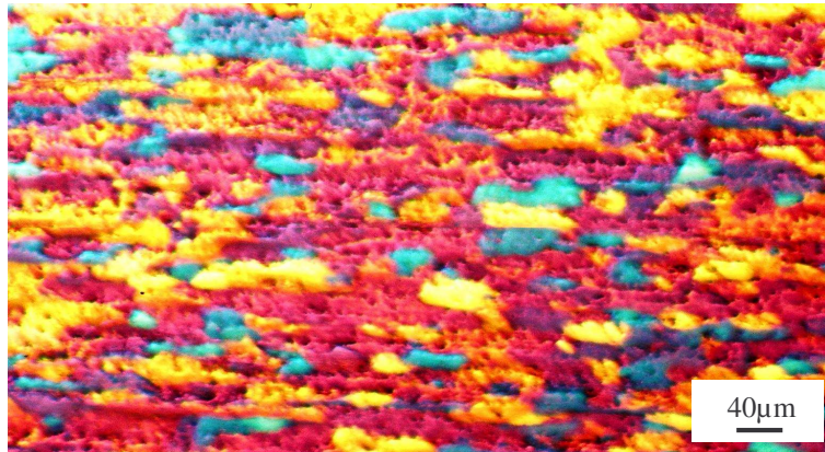
Şekil Ek 1.35 5. prosese ait 1mm kalınlığındaki tavlı malzemenin döküm yönüne paralel kesit merkez bölgesi
