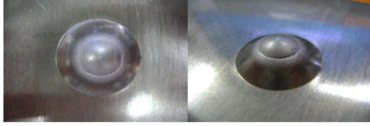
Şekil Ek 3.1 1. prosese ait yeniden kristalleşme tavlı görmüş malzemenin erichsen testi sonrası görüntüsü
