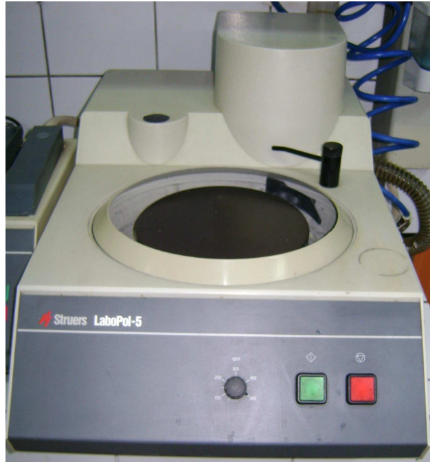
Şekil Ek 7.4 Makro ve mikro yapı numunelerinin zımparalama ve mekanik parlatma işlemlerinin yapıldığı Struers LaboPo-5 marka mekanik parlatma cihazı.
