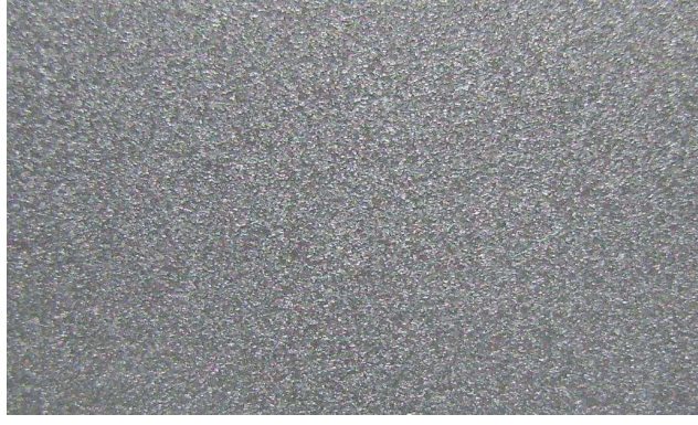
Şekil Ek 6.4 5,50mm kalınlığında 550°C sıcaklıkta homojenleştirme tavlı sonrası yüzey tane görüntüsü
