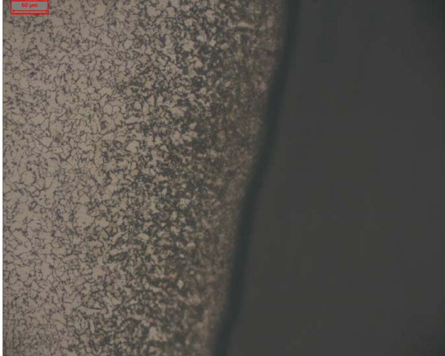
Şekil 7.42 Isıdan etkilenen bölgenin mikro yapısı
