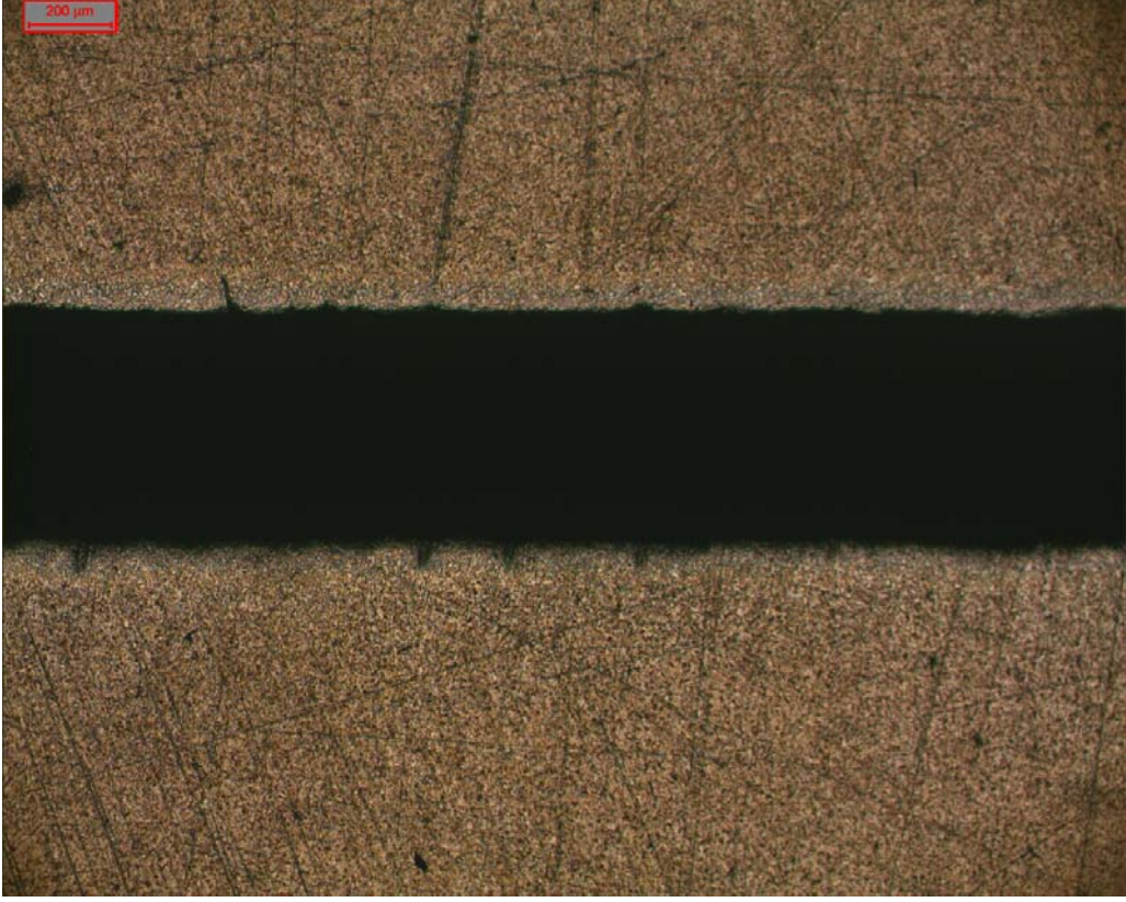
Şekil 7.61 5.6 Nolu numunenin dikey kesim doğrultusundaki 50X büyütmedeki görüntüsü
