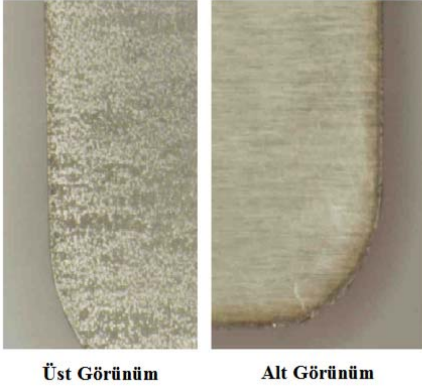
Şekil 6.5 Laserle kesilmiş parçanın alt ve üstten görünümü
