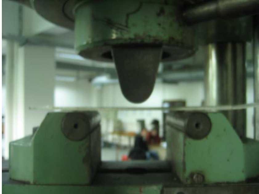
Şekil 5.10 Eğme deneyi sırasında numunenin makineye yerleştirilmesi
