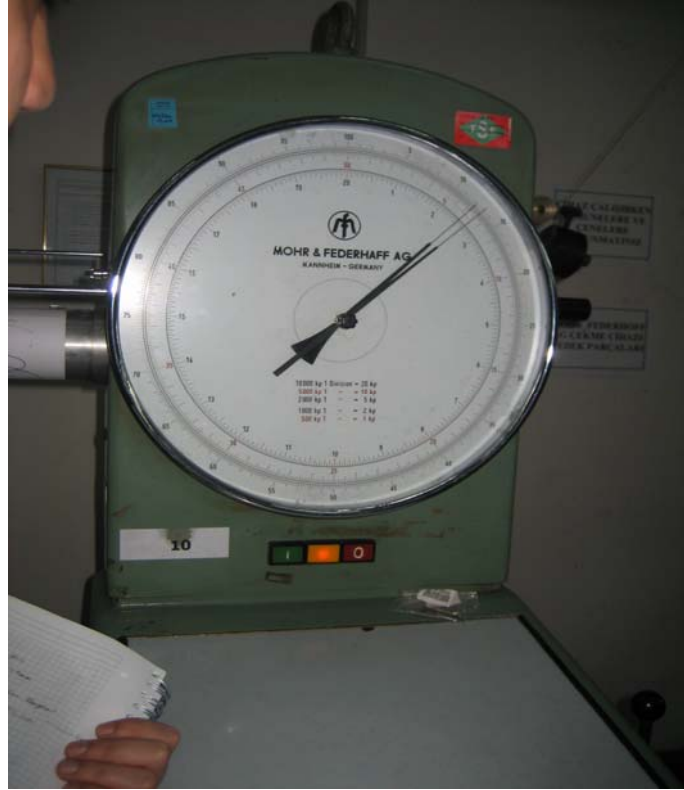
Şekil 5.6 Numune koptuğu sırada çekme cihazının gösterdiği değeri kaydedilmesi
