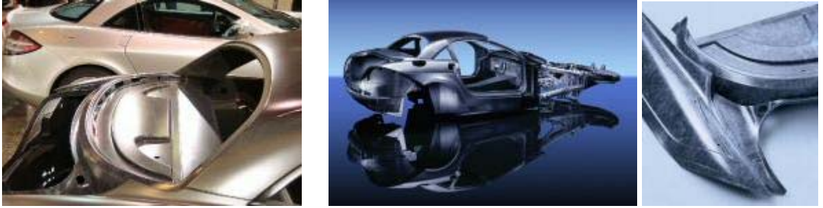
Şekil 3.16 SMC yöntemi ile üretilmiş otomobil gövdesi
