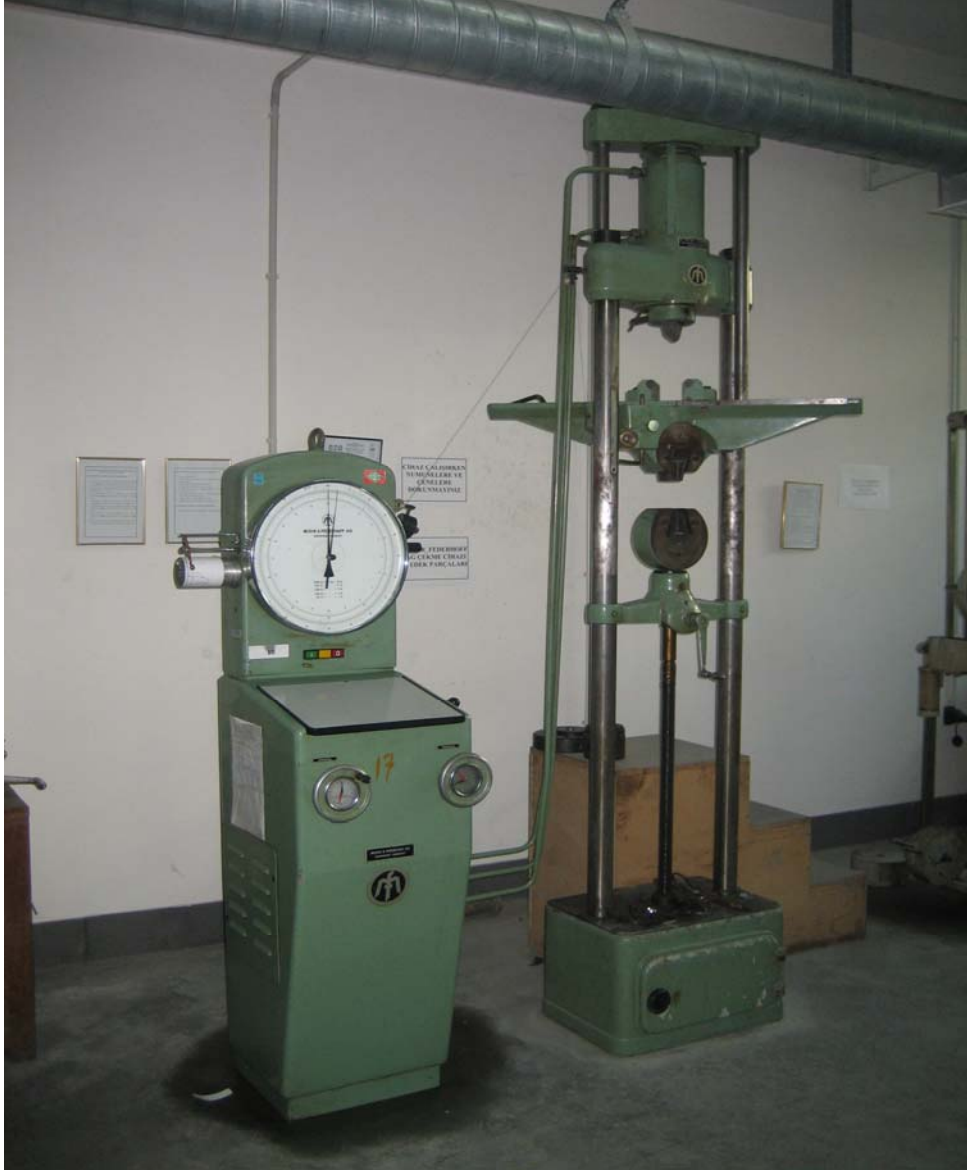
Şekil 5.3 YTÜ Laboratuvarındaki Mohr Federaf Çekme Cihazı
