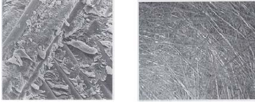
Şekil 2.8 Cam elyafın kompozit içindeki SEM görüntüsü
