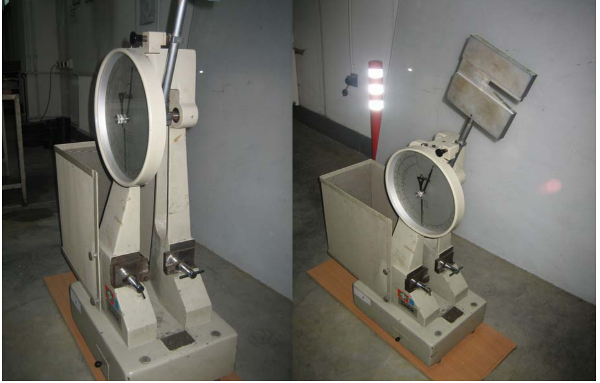
Şekil 5.11 Darbe Deneyinde kullanılan makinenin görüntüsü
