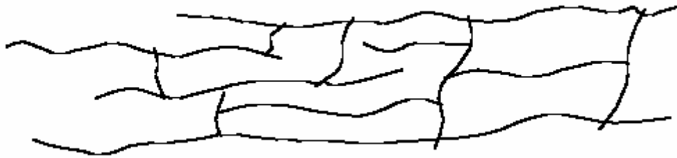
Şekil 2.2 Termoset moleküllerin kür işlemi sırasında çapraz bağlanması (Ersoy, 2005)
