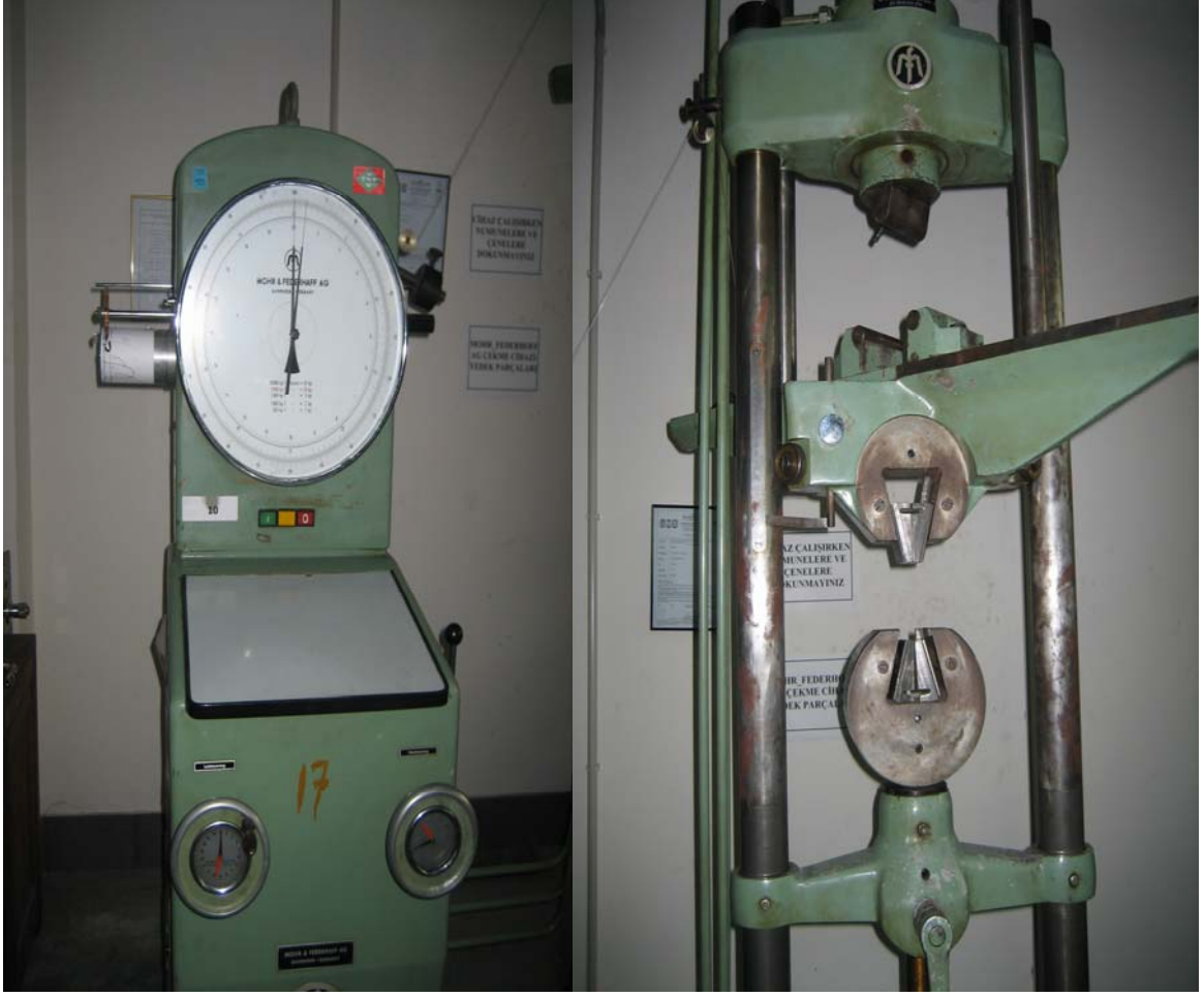
Şekil 5.4 Deneyde kullanılacak çekme cihazının görüntüsü
