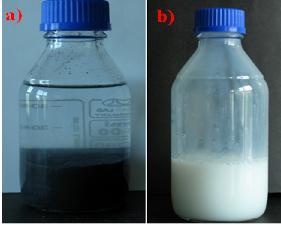
Şekil 6.4 Hidrotermal sentezlemenin ardından a) CNT/böhmit ve b) böhmit süspansiyonları.
