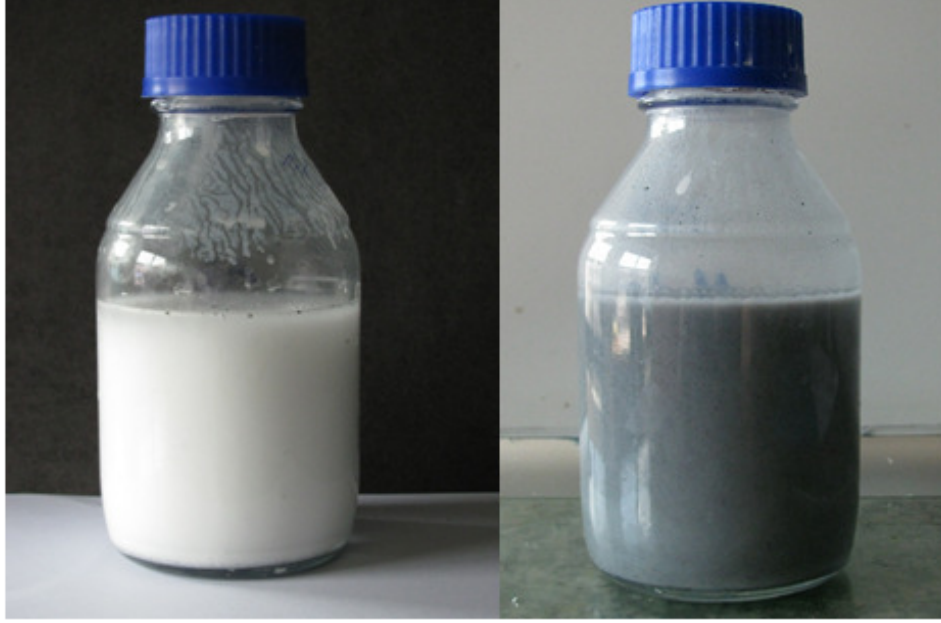
Şekil 6.3 a) Manyetik karıştırma sonrası CNT/alüminyum asetat karışımı, b) ultrasonik karıştırmanın ve amonyak ilavesinin ardından CNT/alüminyum asetat karışımı.
