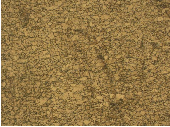
Şekil 4.7 CCR–6112 tipi %0,019 Si içeren elektrik motoru yapımına uygun laminasyon sacı. Nital 4X200. Görüntü yüzeyden alınmıştır. Ferritik yapı görülmektedir. Silikat inklüzyonları mevcuttur.
