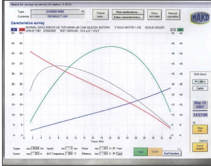
Şekil 4.26 Ereğli CCR-6112 tipi sac kullanılan endüvi ile toplanan L84 tipi cam silecek motoru 2 nolu motor 1.hız soğuk değer.
