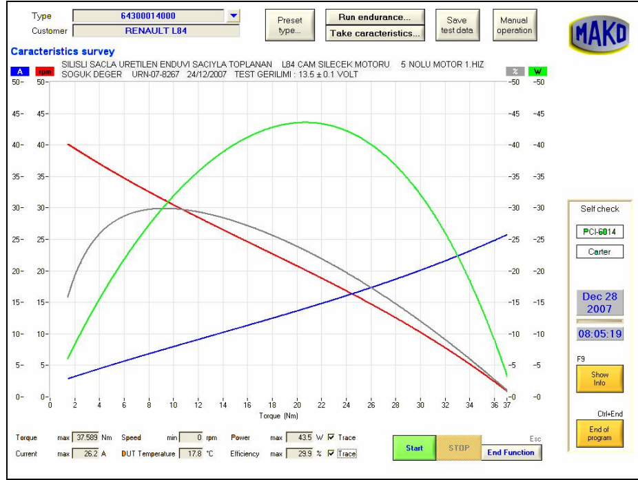
Şekil 4.48 M400 tipi silisli sacla üretilen, endüvi sacı ile toplanan L84 tipi cam silecek motoru 13 nolu motor 1.hız soğuk değer
