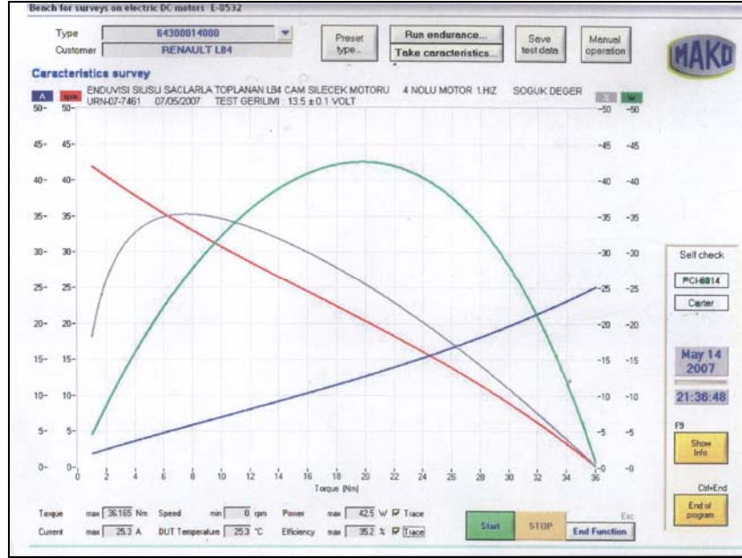
Şekil 4.38 Erdemir 6109 tipi laminasyon çeliği kullanılarak yapılan endüvi ile toplanan L84 tipi cam silecek motoru 8 nolu motor 1.hız soğuk değer.
