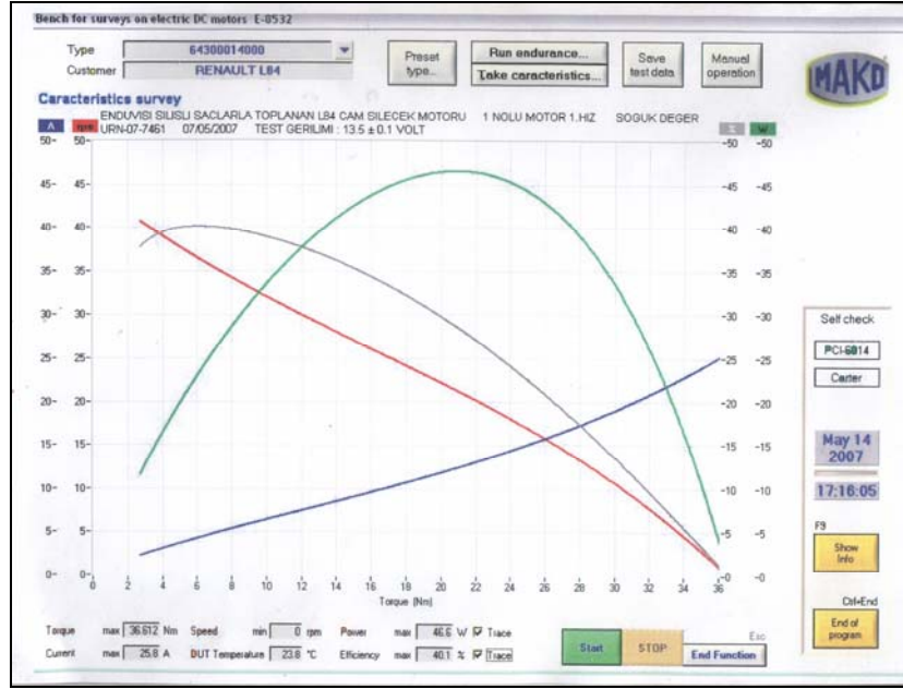
Şekil 4.32 Erdemir 6109 tipi laminasyon çeliği kullanılarak yapılan endüvi ile toplanan L84 cam silecek motoru 5 nolu motor 1.hız soğuk değer
