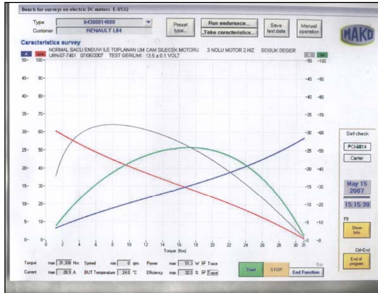
Şekil 4.29 Ereğli CCR–6112 tipi sac kullanılan endüvi ile toplanan L84 tipi cam silecek motoru 3 nolu motor 2.hız soğuk değer.
