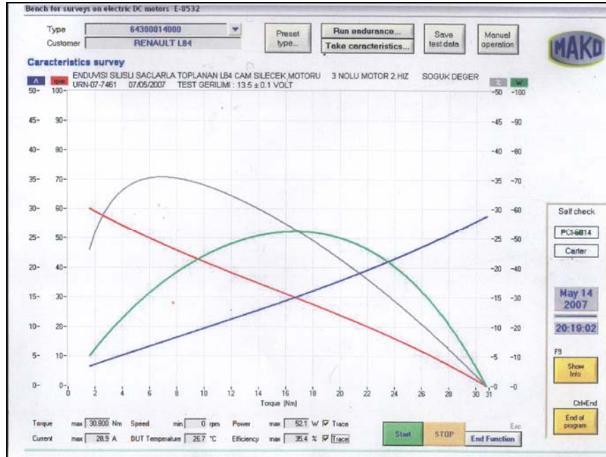
Şekil 4.37 Erdemir 6109 tipi laminasyon çeliği kullanılarak yapılan endüvi ile toplanan L84 cam silecek motoru 7 nolu motor 2.hız soğuk değer
