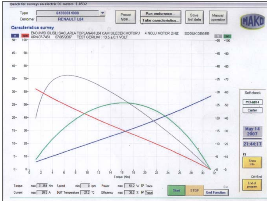
Şekil 4.39 Erdemir 6109 tipi laminasyon çeliği kullanılarak yapılan endüvi ile toplanan L84 cam silecek motoru 8 nolu motor 2.hız soğuk değer.
