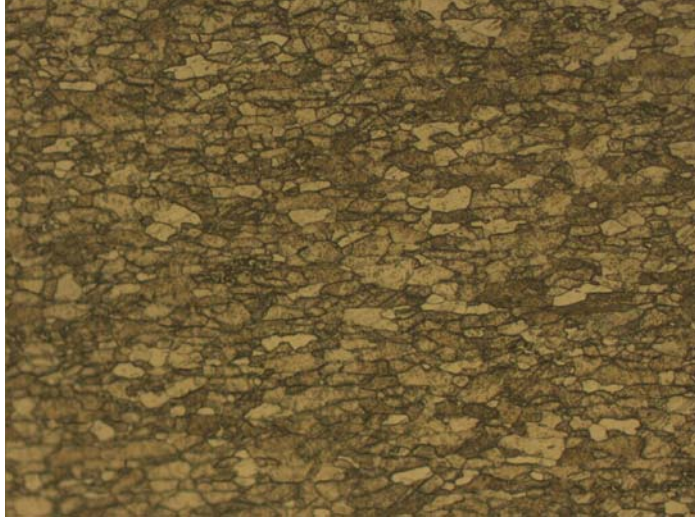
Şekil 4.9 CCR-6112 tipi %0,019 Si içeren elektrik motoru yapımına uygun laminasyon sacı. Nital 4X500. Görüntü kesitten alınmıştır
