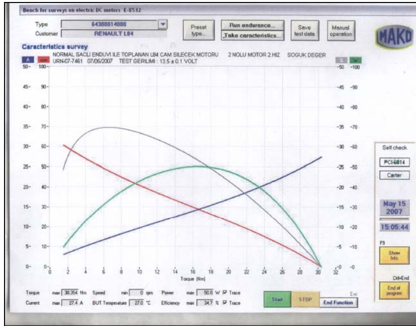
Şekil 4.27 Ereğli CCR-6112 tipi sac kullanılan endüvi ile toplanan L84 tipi cam silecek motoru 2 nolu motor 2.hız soğuk değer.
