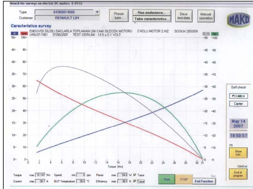
Şekil 4.35 Erdemir 6109 tipi laminasyon çeliği kullanılarak yapılan endüvi ile toplanan L84 cam silecek motoru 6 nolu motor 2.hız soğuk değer
