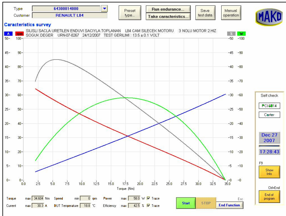
Şekil 4.45 M400 tipi silisli sacla üretilen, endüvi sacı ile toplanan L84 tipi cam silecek motoru 11 nolu motor 2.hız soğuk değer
