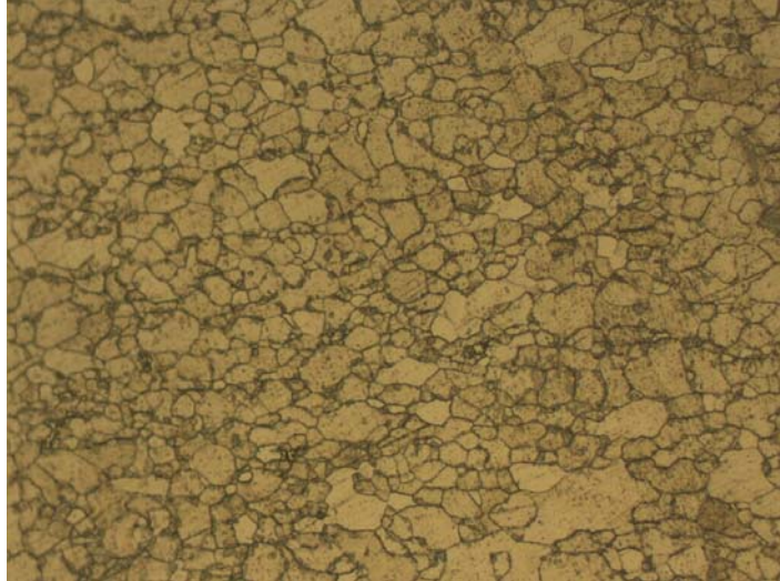
Şekil 4.8 CCR–6112 tipi %0,019 Si içeren elektrik motoru yapımına uygun laminasyon sacı. Nital 4X500. Görüntü yüzeyden alınmıştır.
