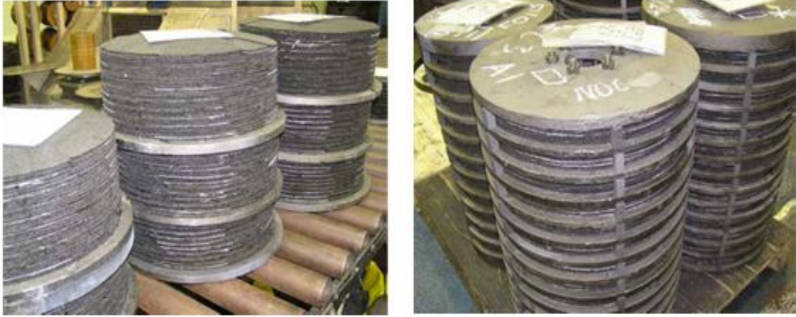
Şekil 5.24 Fırına yerleştirilmek üzere hazırlanan diskler
