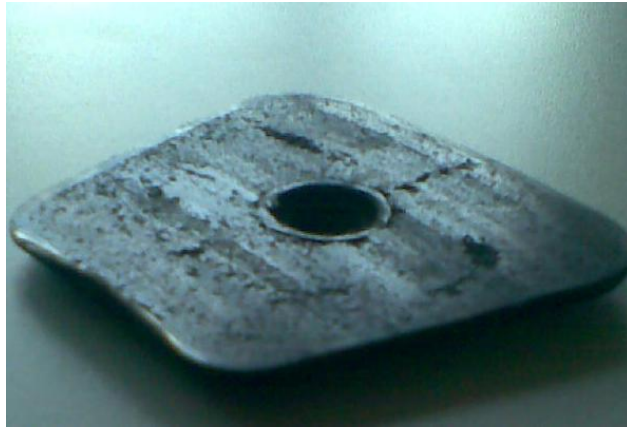
Şekil 5.36 Taşıyıcı diske sabitlenen ped ve perçin deliğinden başlayarak ilerleyen çatlak
