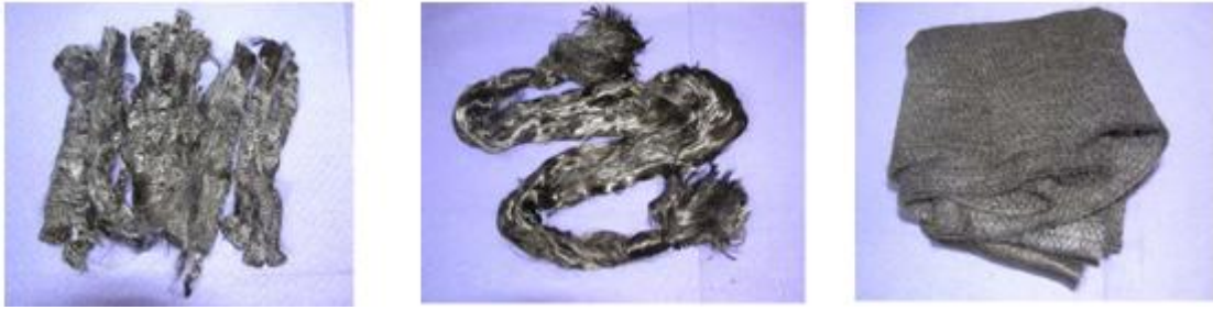
Şekil 5.20 Dokunmuş PAN fiber malzemeleri
