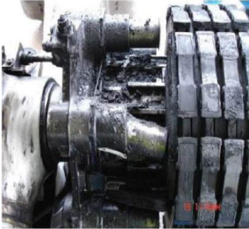
Şekil 5.45 Fren ünitesinin RTO sonrası durumu
