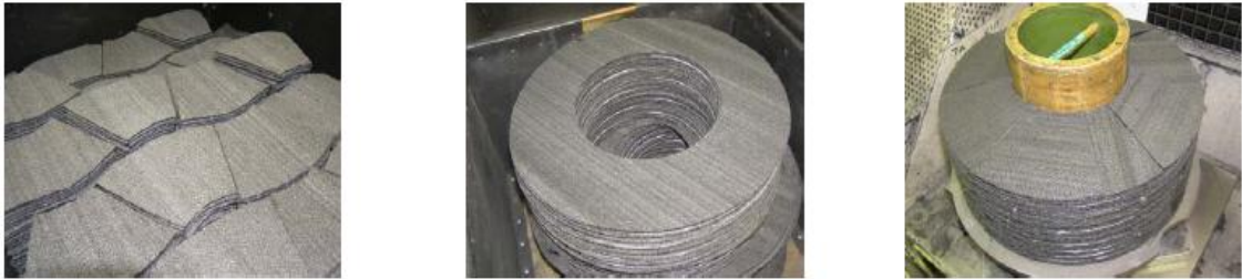
Şekil 5.21 Belirli şekillere göre kesilmiş disk ve pedler
