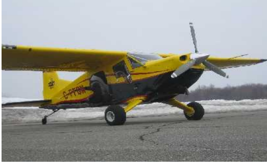
Şekil 2.3 Kuyruktan tekerlekli bir uçak
