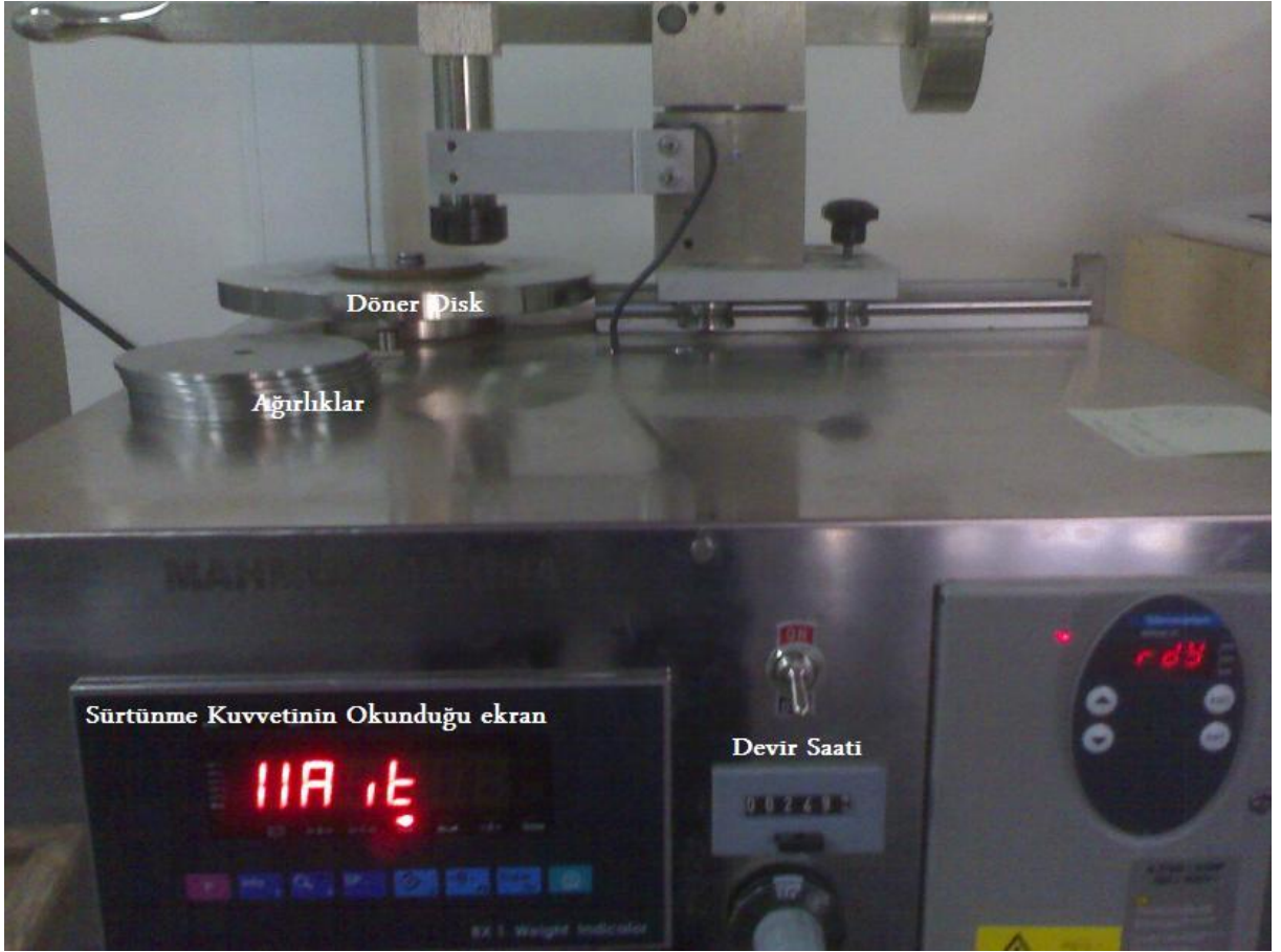
Şekil 6.6 Deneylede kullanılan Pin-on disk test cihazı
