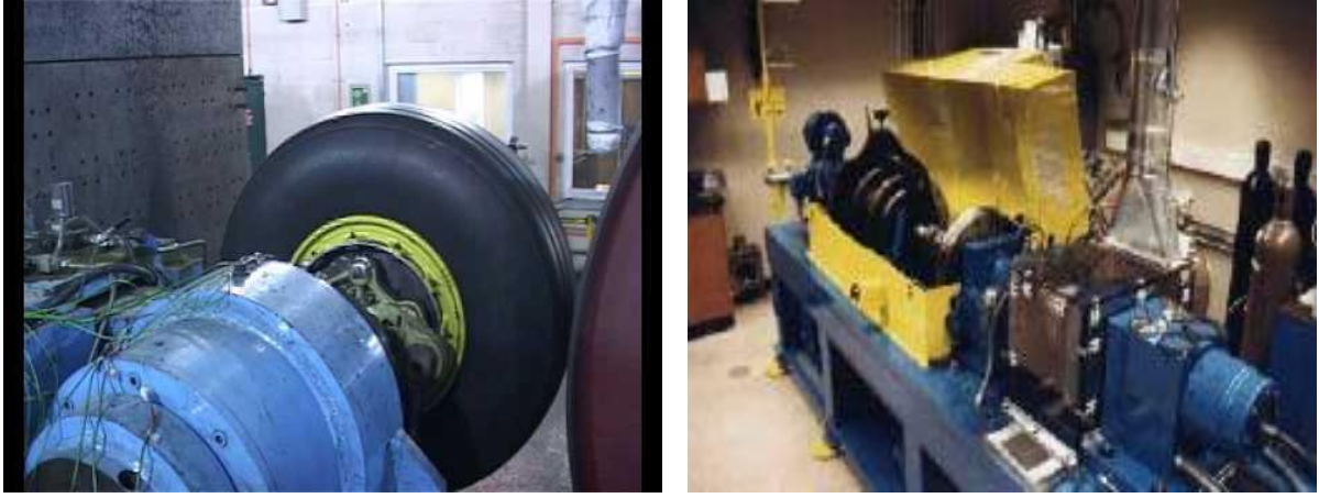
Şekil 5.26 Gerçek uçak lastiği üzerinde ve laboratuvar ölçekli test koşullarına ait dinamometre düzenekleri
