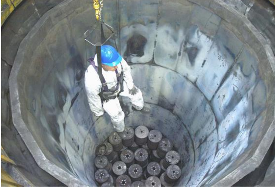
5.25 Disklerin fırına yerleştirilmesi
