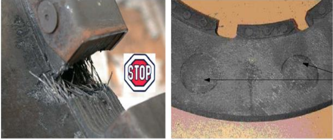
Şekil 5.44 Yapıda kopma ve pistonların itmesi sonucu oluşmuş hasarlar
