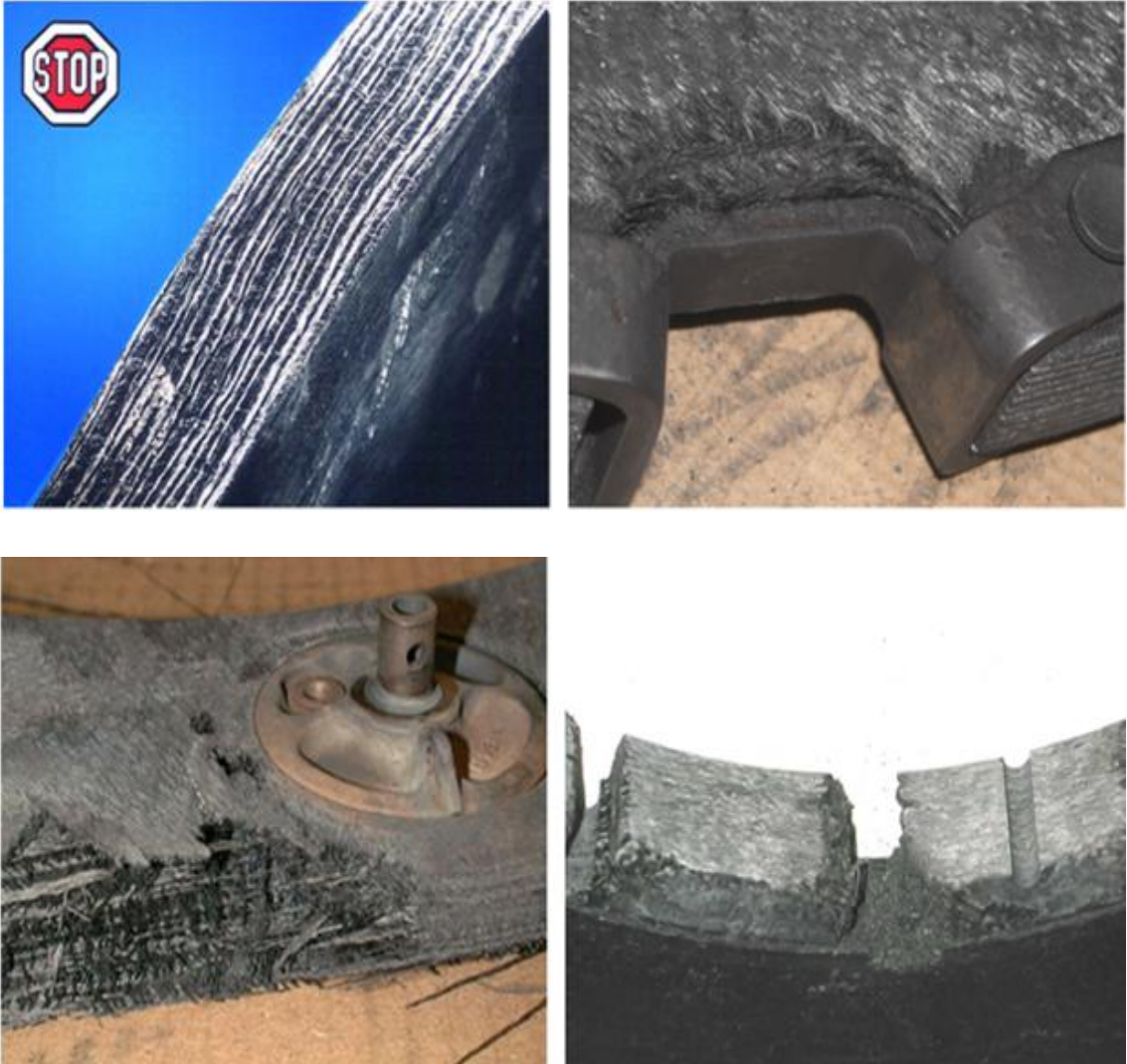
Şekil 5.43 Termal oksidasyon sonrası açığa çıkmış fiberler (Messier Bugatti CMM, 2009)
