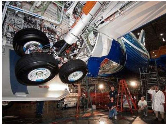
Şekil 4.3 Ana iniş takımının gövde içersine alınması
