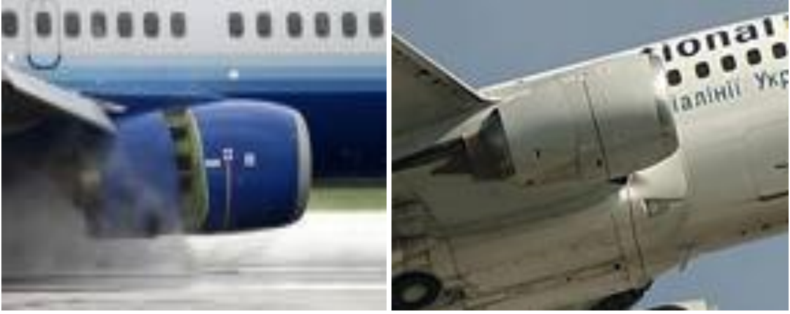
Şekil 3.7 Thrust Reverse halindeki motor ile uçuş sırasındaki motorun durumu
