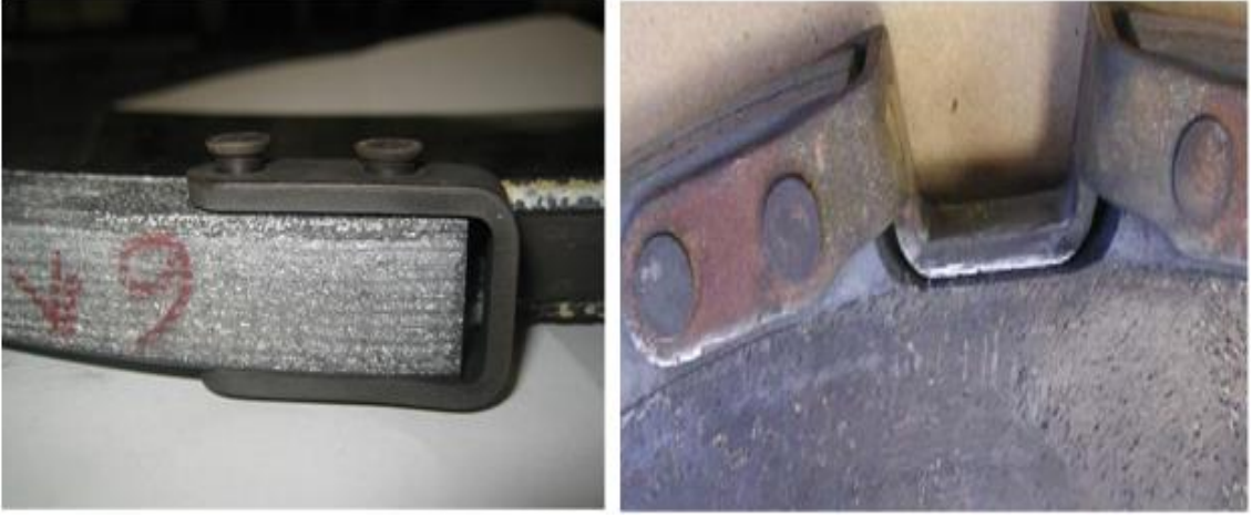
Şekil 5.39 Perçinlerde gevşeklik ve klipte korozyon
