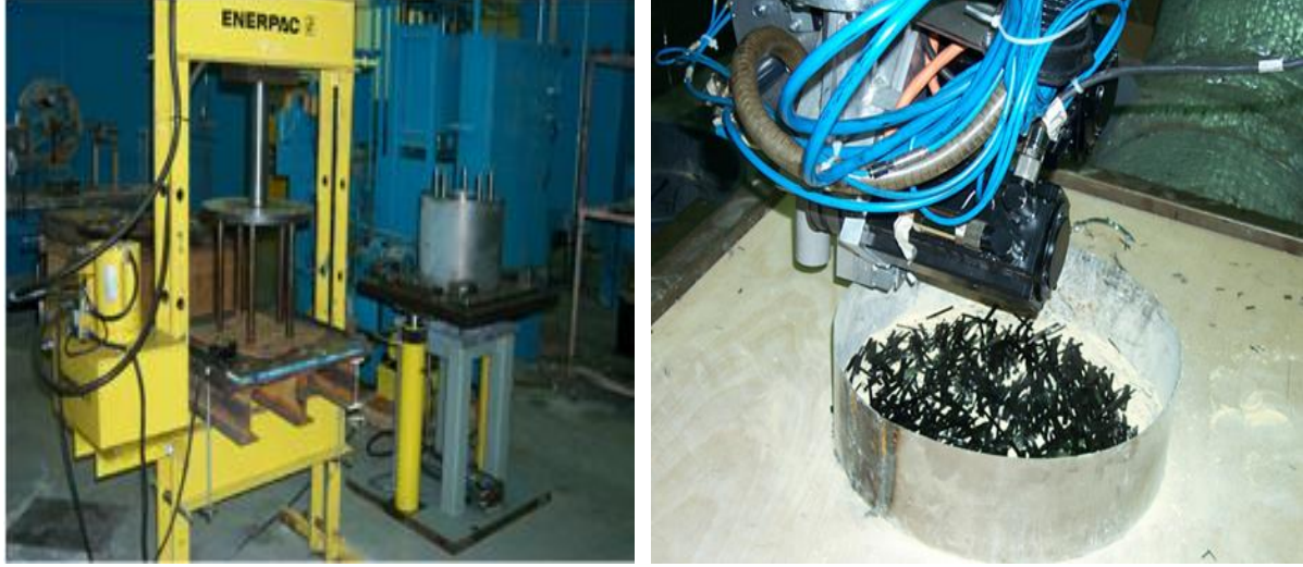
Şekil 5.11 Disk şekillendirmede kullanılan pres ve kesici başlık
