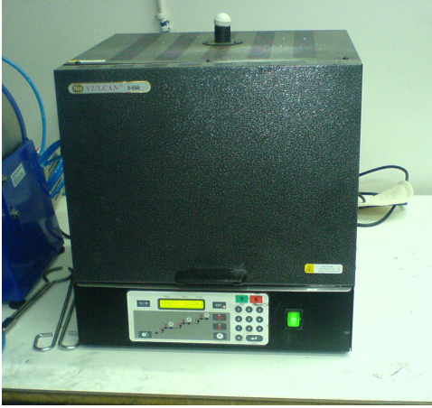
Şekil 10.5 Kalıp malzemesinin pişirilmesi
