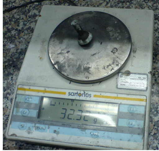
Şekil 10.8 Üretilen yeni paslanmaz çelik numunenin hassas olarak tartılması
