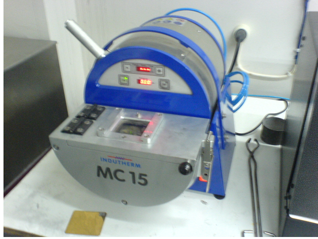
Şekil10.6 Hurda ve alaşımın vakum ergitme fırınına yüklenmesi
