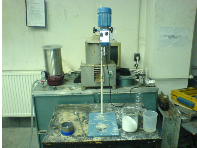
Şekil 10.3 Kalıp malzemesinin karıştırılması için mikserin kurulması
