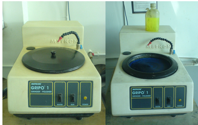
Şekil 13. Numune hazırlamak için kullanılan zımparalama ve parlatma cihazları
