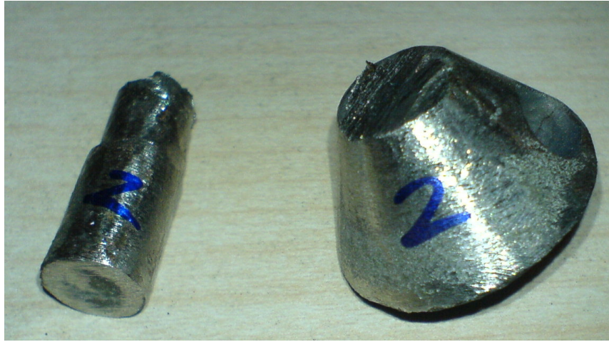
Şekil 10.11 2. numunenin ısıtım için kesilmiş hali
