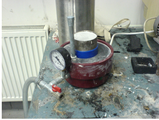
Şekil 10.4 Kalıp malzemesinin içindeki gözenekleri titreşimle gidermesi işlemi
