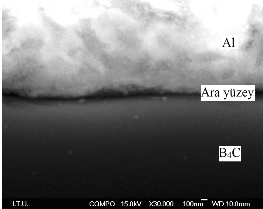
Şekil 6.20 32 μm partikül boyutuna sahip kaplanmamış (as-received) B 4 C içeren AMK malzemenin Al- B 4 C arayüzeyi SEM görüntüsü
