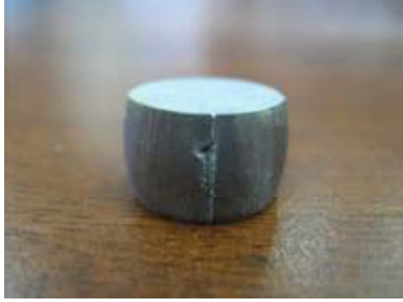
Şekil 5.13 Basma deneyinde uygulanan yük ile numune yüzeyinde oluşan çatlak
